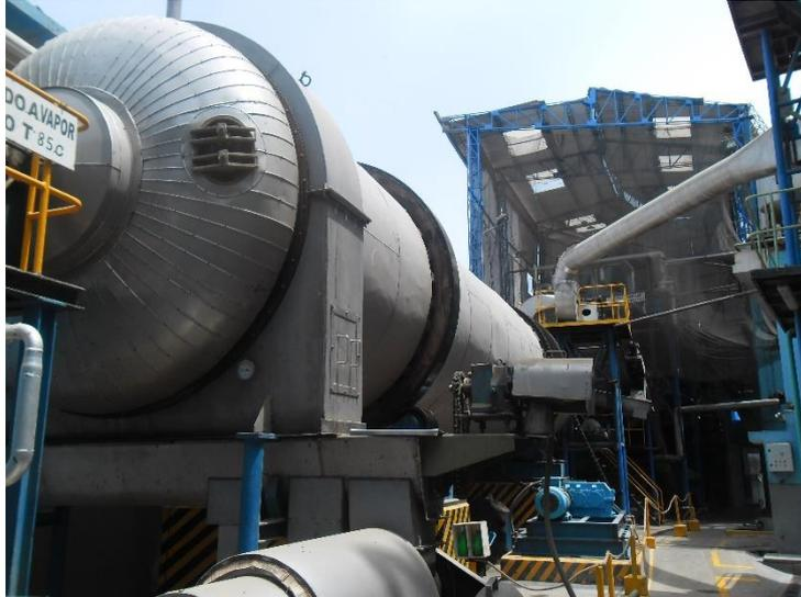
Figura N° 10: Secador Rotadisco
