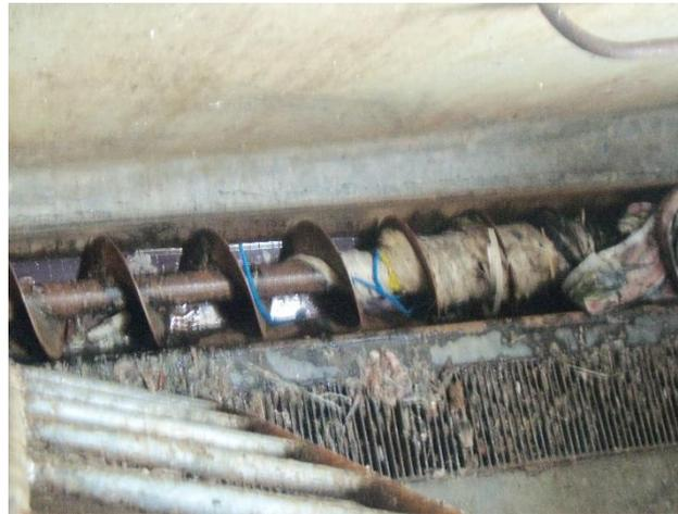
Figura N° 47: Impurezas en el transportador Helicoidal
