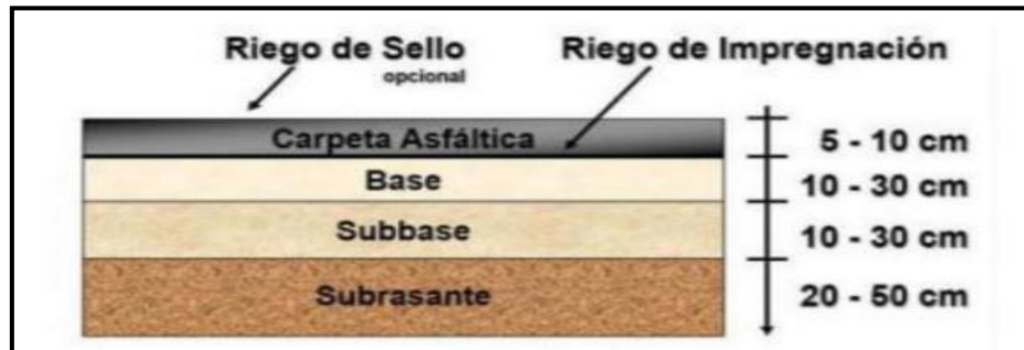
Figura N°5: Estructura del Pavimento Asfáltico
