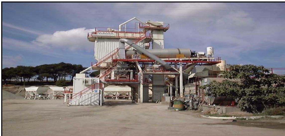
Figura N°15: Planta discontinua con doble tambor secador para calentamiento del RAP de la empresa PABASA
