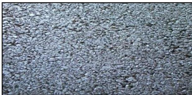
Figura N° 5: Mezcla Asfáltica Porosa
