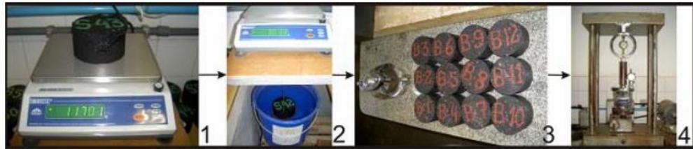
Figura N° 13: Ensayo de estabilidad y fluidez Marshall
