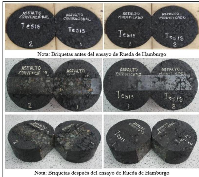
Figura N° 21: Imágenes de probetas de ambas mezclas asfálticas (antes y después del ensayo de Rueda de Hamburgo)
