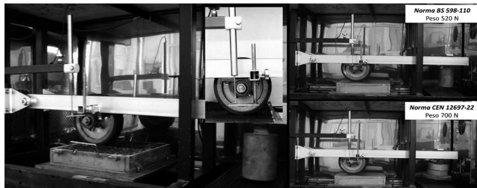
Figura N° 14: Equipo de Wheel Tracking Teste
