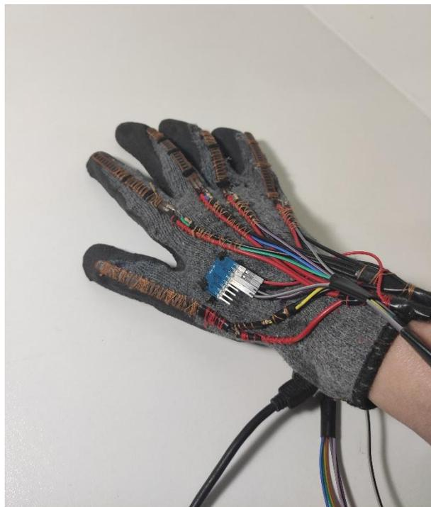
Figura N° 7: Prototipo de guantes electrónicos para la traducción de la LSP
