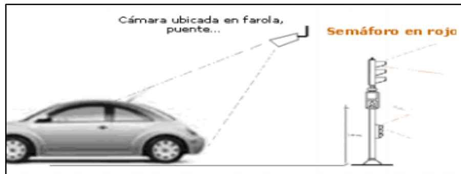
Figura 5. Ejemplo de sistema de monitoreo de infracciones de tránsito. La cámara reconoce la placa del vehículo al pasar la luz roja.
