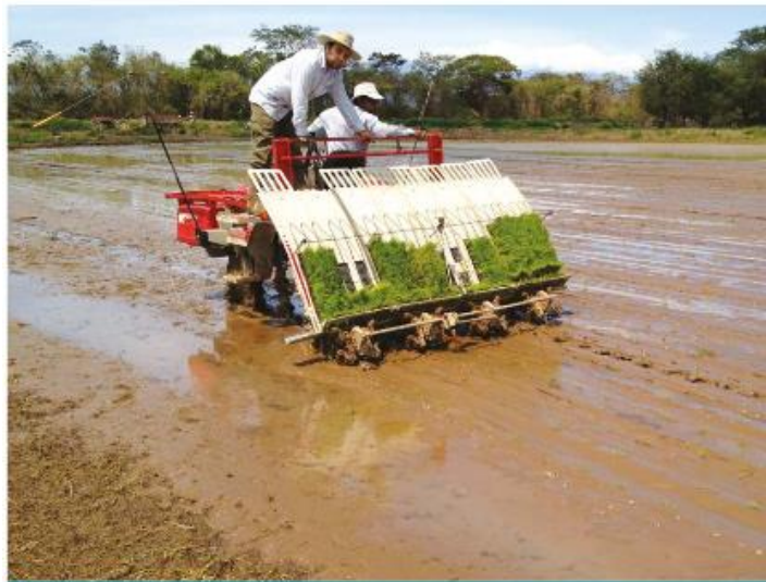
Figura 18. Trasplantadora mecanizada autopropulsada de 8 hileras.
