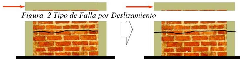
Figura 2 Tipo de Falla por Deslizamiento
