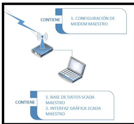
Figura 88. Etapa de configuración del sistema SCADA y equipo de comunicación GPRS
