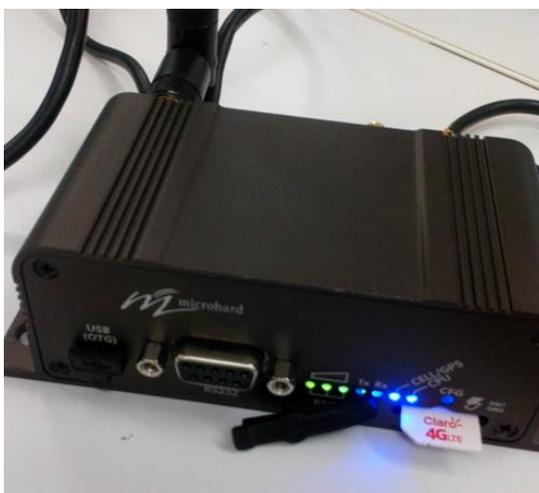
Figura 96. Instalación del módem GPRS maestro para el SCADA
