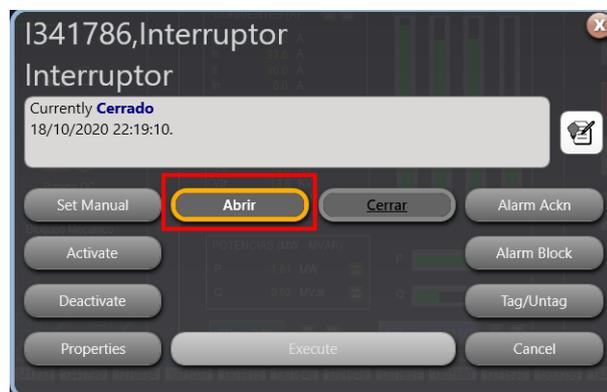
Figura 113. Maniobra de apertura desde el software SCADA
