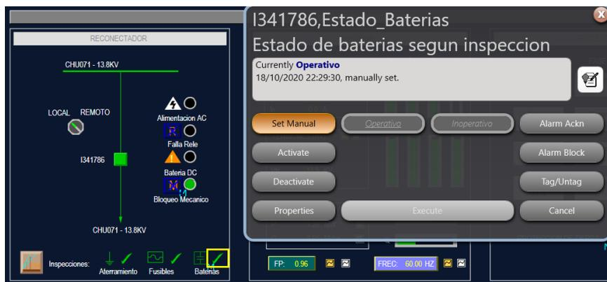
Figura 101. Pruebas simuladas de control desde la interfaz gráfica desarrollada en el software SCADA
