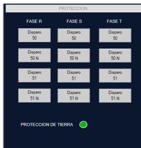
Figura 122. Restablecimiento de la protección a tierra desde la interfaz gráfica del software SCADA
