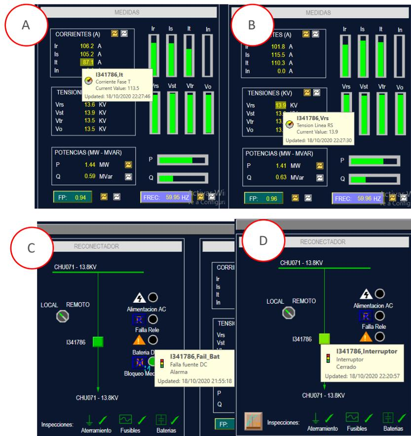
Figura 107. Señales supervisadas desde la interfaz gráfica del software SCADA: A) Corrientes de fase. B) Tensiones bifásicas. C) Alarmas de falla. D) Estado de interruptor.
