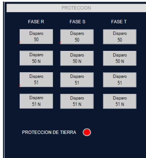
Figura 121. Deshabilitación de la protección a tierra mostrada en la interfaz gráfica del software SCADA
