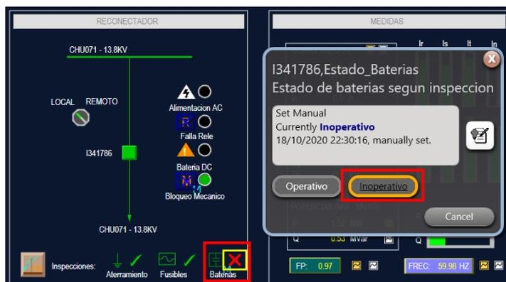
Figura 104. Selección de control de estado operativo desde la interfaz gráfica del software SCADA
