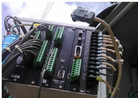
Figura 128. Desconexión del cable de serial en el reconector para generar una falla de comunicación
