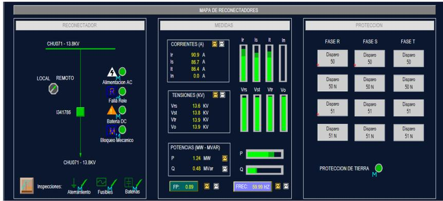
Figura 100. Vista interna del reconectador I341786 desarrollada en el software SCADA
