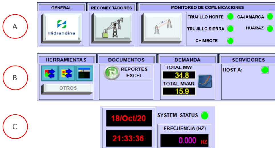
Figura 67. Opciones de la barra de herramientas diseñadas en el software SCADA: A) Sección de botones generales y monitores. B) Sección de reportes y herramientas cliente. C) Sección de información general.
