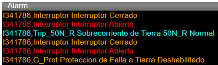
Figura 120. Panel de alarmas que muestra la protección a tierra deshabilitada desde el software SCADA
