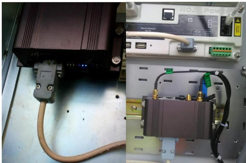
Figura 95. Conexión del cable serial al puerto RS-232 del módem GPRS
