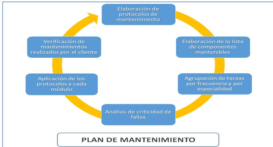
Figura 35: Proceso de la elaboración del protocolo del plan de mantenimiento. Elaboración propia.
