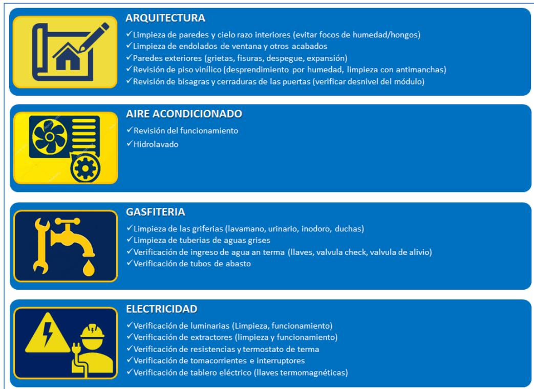
Figura 18: Acciones ejecutadas por especialidad en el mantenimiento. Empresa de Alquiler de Soluciones Modulares.
