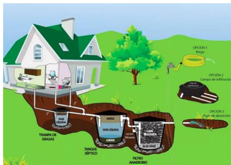
Figura N° 79 Esquema referencial de proceso de biodigestor
