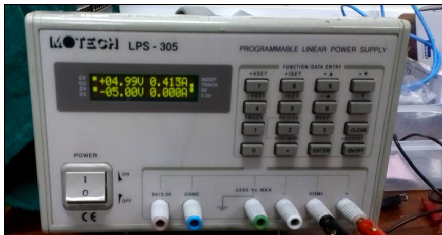
Figura 48. Verificación del consumo de corriente en modo Stand By.
