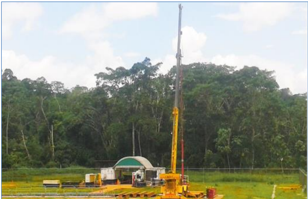
Figura 04: Operación de bajada de herramienta al pozo con unidad de Slickline. Tomado en operaciones de Camisea, por elaboración propia
