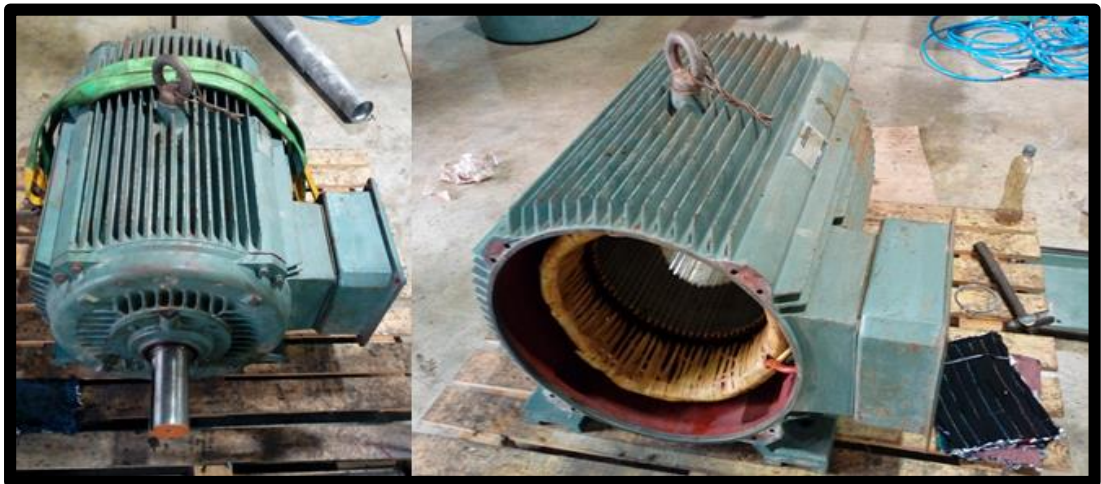
Figura 47. Inspección de Motor Eléctrico
