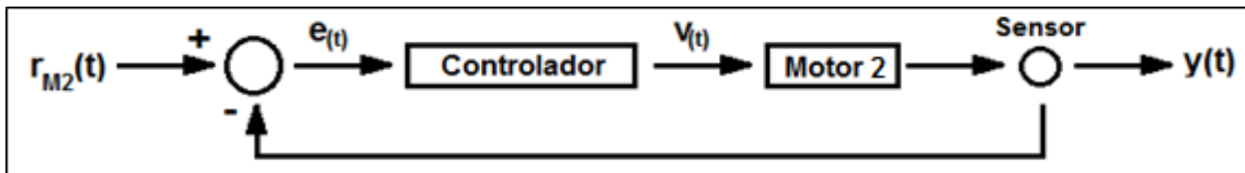
Figura 3.48 Diagrama del sistema de control del motor 2 Fuente: Elaboración propia en Paint (2015)
