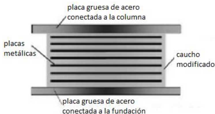
Figura 20: Partes del aislador Tipo HDR
