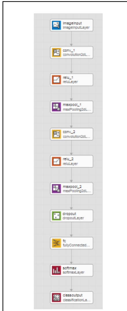
Figura 18. Diagrama de bloques de la arquitectura de la red neuronal
