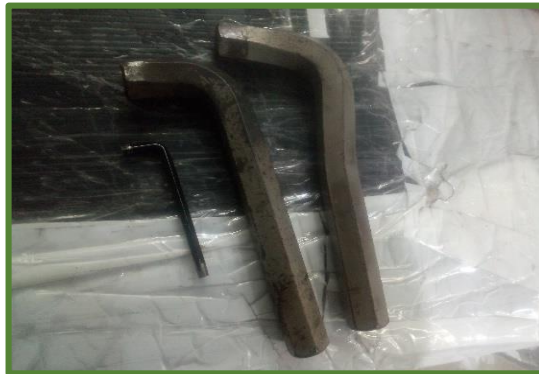
Figura 19. Llaves allen en mal estado Fuente: Datos de la empresa. Elaboración Propia
