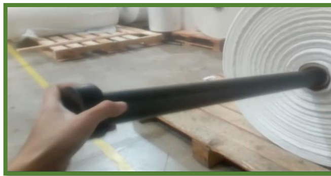
Figura 40. Dispositivo Poka Yoke en tucó contraído Fuente: Datos de la empresa. Elaboración Propia
