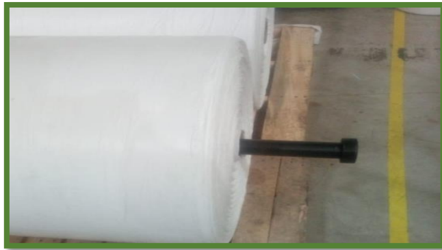
Figura 38. Dispositivo Poka Yoke en la bobina Fuente: Datos de la empresa. Elaboración Propia
