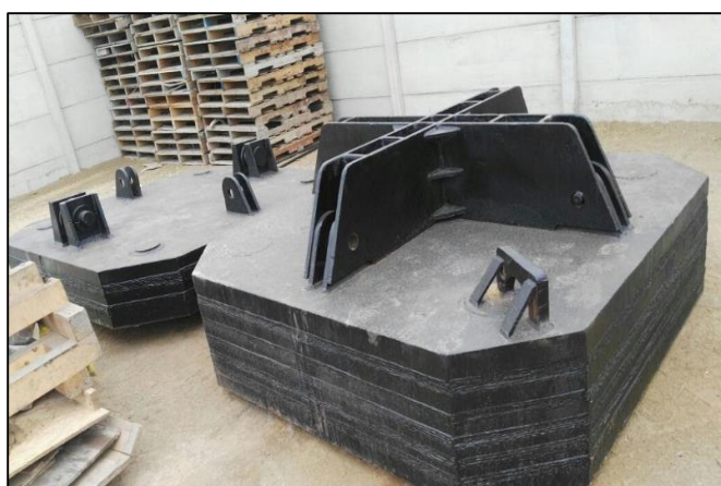
Figura N° 27: Masas de 15 y 9 toneladas para compactación
