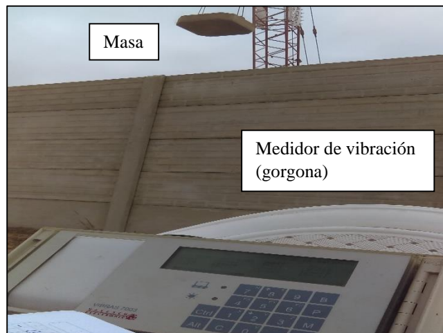
Figura N° 66: Medición de vibración por impactos de masa Fuente: Elaboración propia.
