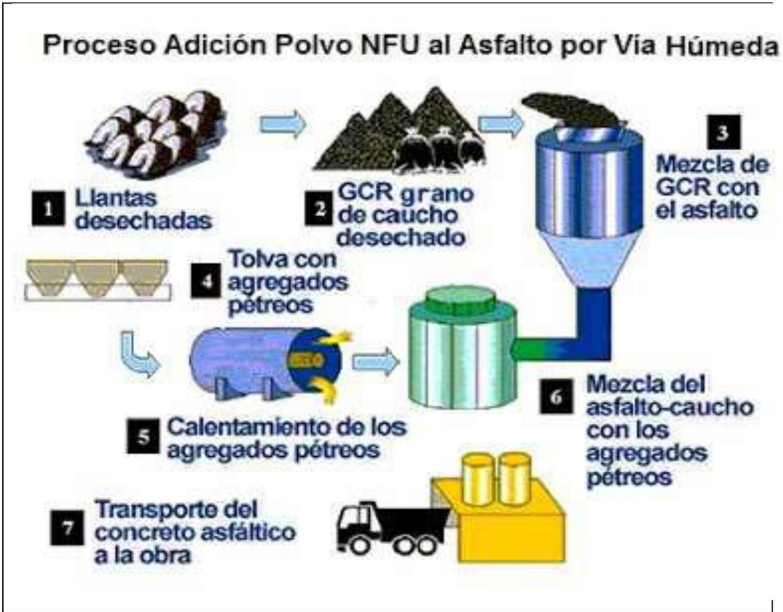
*Figura 5. Esquema de fabricación de asfalto modificado con caucho por vía húmeda. Adaptado de Bermejo (2010).*
