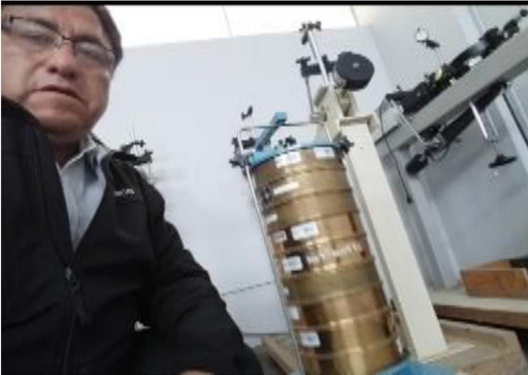
*Figura 4. Granulometría del Grano de Caucho reciclado.*
