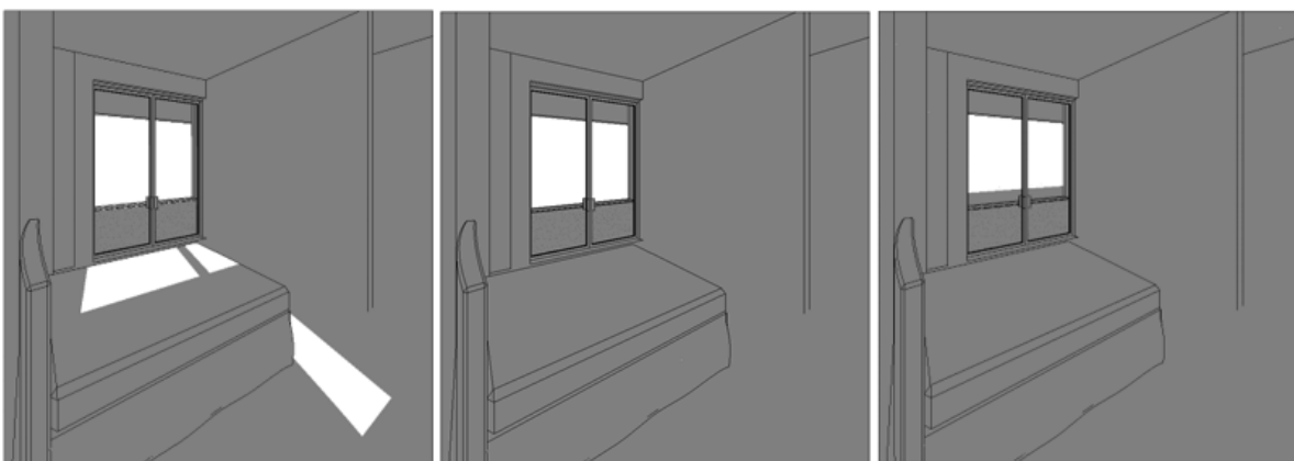
Figura 23. Habitación orientada al este en horas 8:00am, 12:00m y 16:00pm respectivamente. Elaboración Propia en Revit
