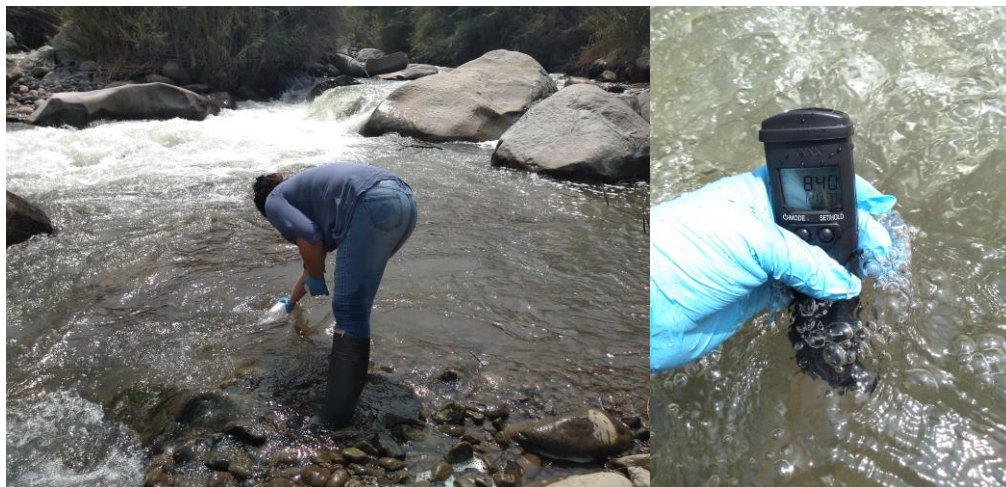
Figura9. Toma de muestra de agua y medida in situ de los parámetros físicos.
