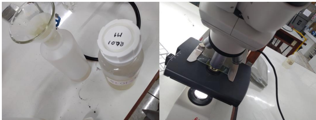
Figura32. Filtración de las muestras de agua en papel Whatman y su posterior observación en el microscopio.
