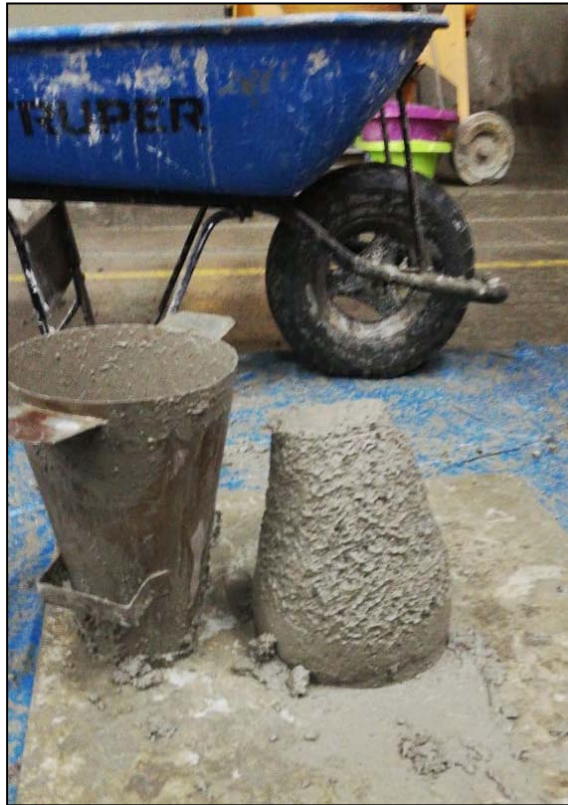
Figura 34: Ensayo de asentamiento en Cono de Abrahams Fuente: Elaboración Propia
