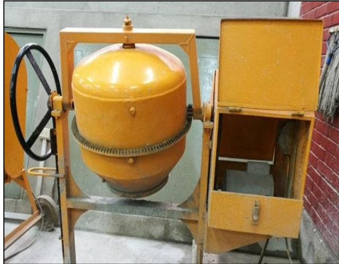
Figura 20: Mezcladora de concreto Fuente: Elaboración propia
