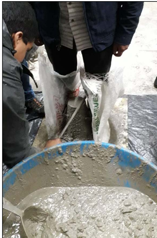
Figura 33: Ensayo de asentamiento en Cono de Abrahams Fuente: Elaboración Propia
