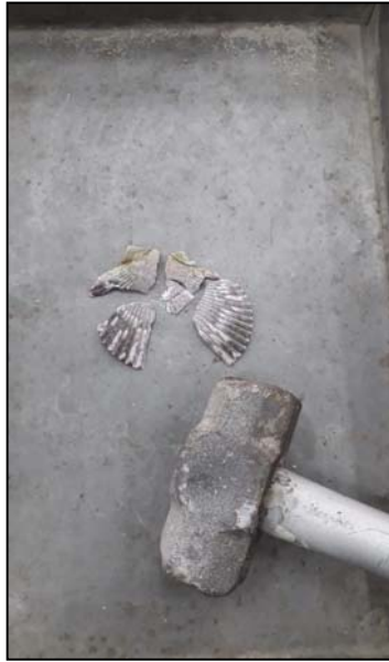
Figura 13: Trituración manual de concha de abanico en estado natural Fuente: Elaboración Propia
