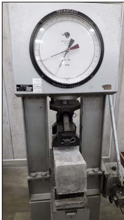
Figura 39: Rotura de probetas después del tiempo establecido según edad Fuente: Elaboración Propia
