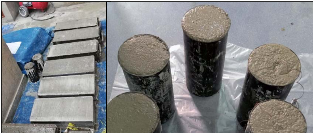
Figura 36: Llenado de concreto en moldes Fuente: Elaboración Propia
