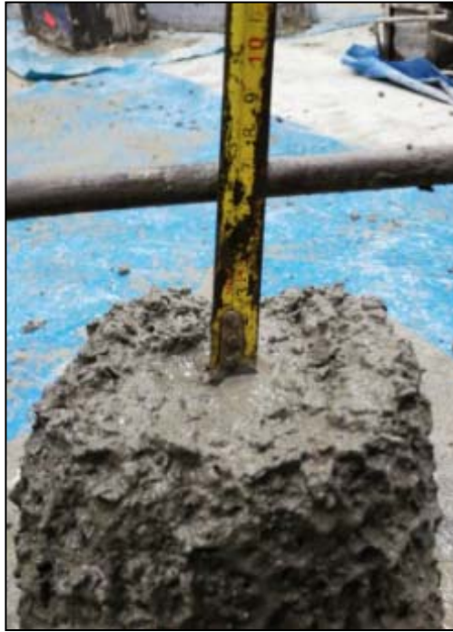
Figura 41: Ensayo de Asentamiento Fuente: Elaboración propia
