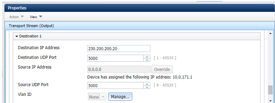
Figura 59: Configuración de IP y puerto en el Transport Stream [2].
