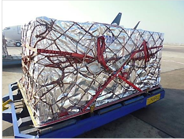
Figura 19. Carga armada con manta térmica Fuente: Elaboración propia
