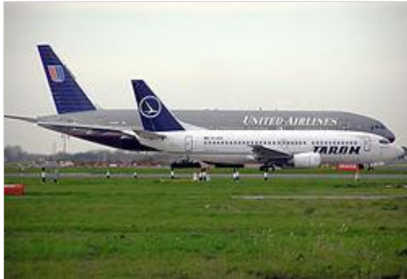
Figura 6. Diferencia de tamaño entre un fuselaje ancho y un angosto
