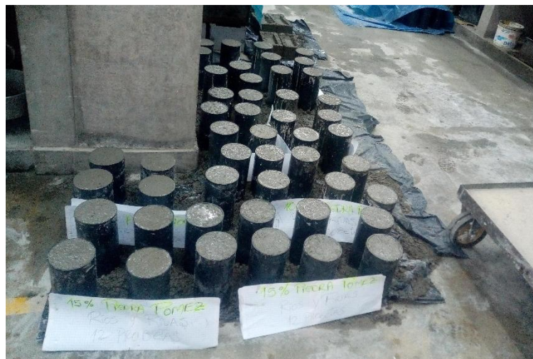
Figura 18: Muestreo de probetas de concreto ligero
