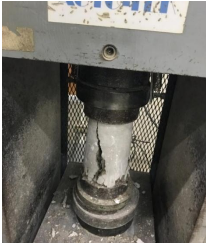
Figura 20: Ensayo de resistencia a la compresión de muestras de probetas
