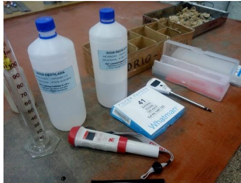
Figura 13: Ensayo químico de PH
