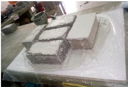
Figura 21: Preparación de ladrillos para ensayo de compresión
