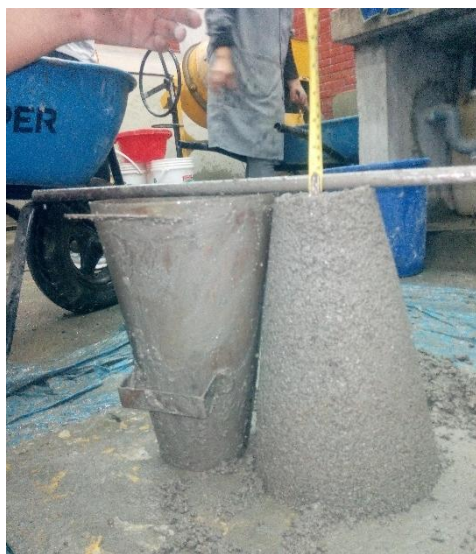
Figura 19: Asentamiento del concreto mediante el ensayo de cono de Abrams.
