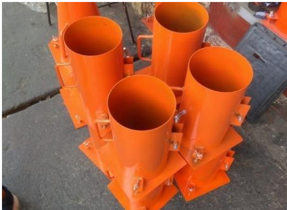
Figura 10. Molde metálico para ensayo de probetas.
