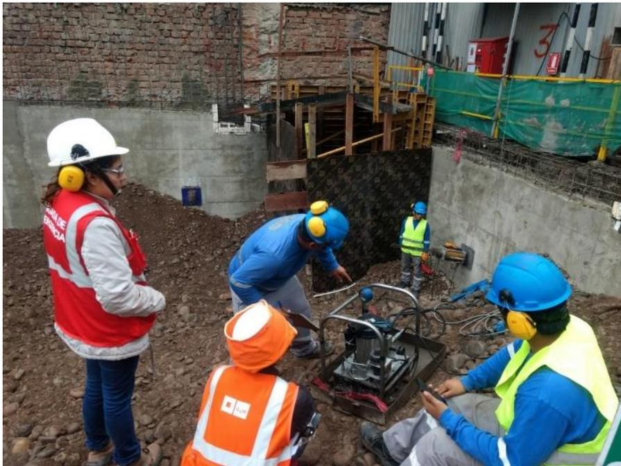
*Figura 31.* Instalación de equipos para ensayo de capacidad
