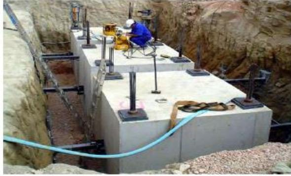
Figura 2. Ensayo de Corte Directo In Situ
