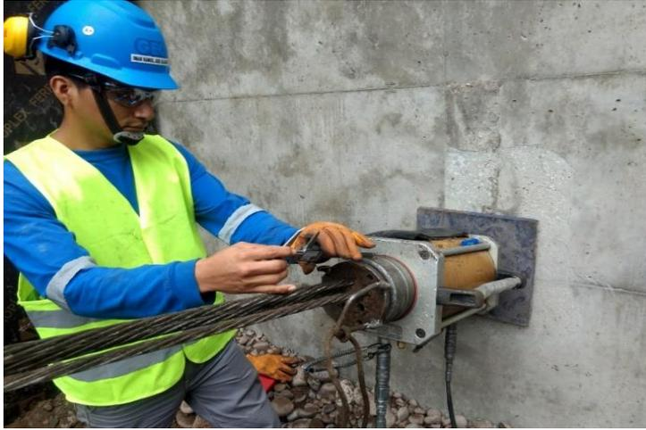
*Figura 32. Medición de la deformación con Vernier*
