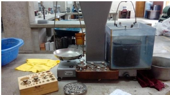
Figura 8. Balanza Hidrostática
