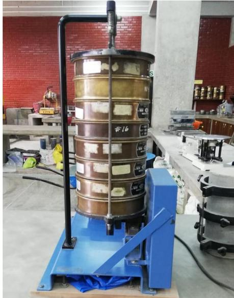
Figura 5. Tamizador eléctrico.
