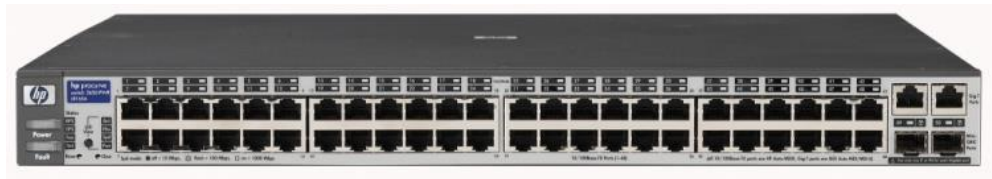
Figura 14: Switch de 50 puertos
