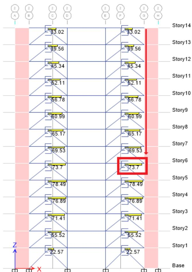
Figura N° 43: Selección de disipador SLB por medio de fuerza cortante en elemento Link
