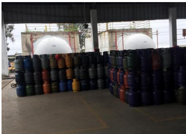
Figura 47: Balones separados para granallar, canje y mantenimiento
