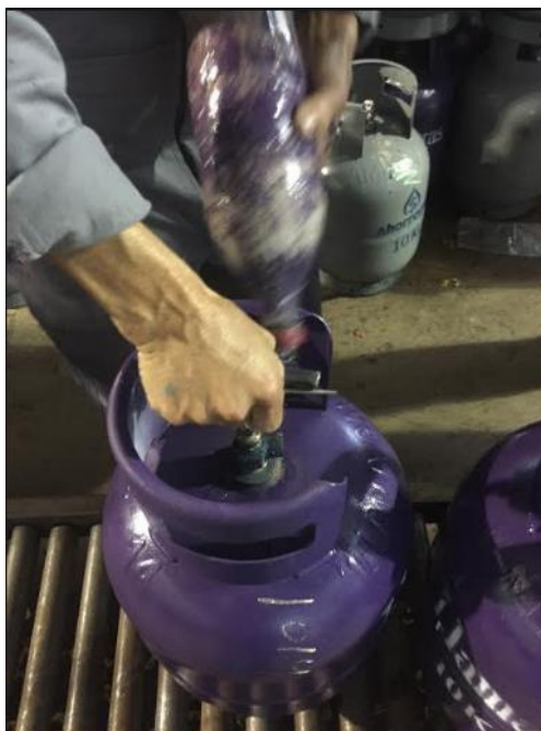
Figura 39: Prueba de hermeticidad (control de fuga) Llamagas S.A
