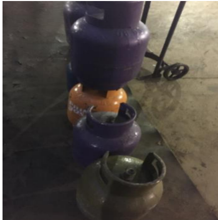
Figura 48: Balones separados para granallar, canje y mantenimiento
