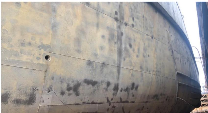
Figura 34. Arenado no uniforme
