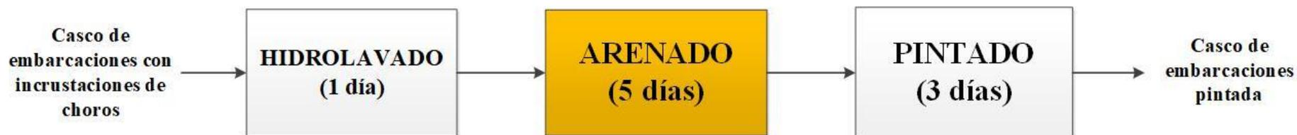
Figura 22. Diagrama de bloques del Tratamiento Superficial
