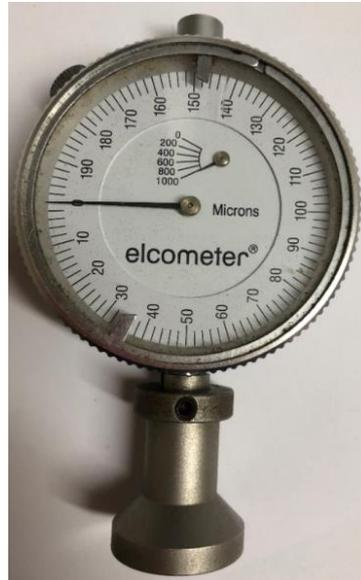
Figura 27. Rugosímetro de superficie
