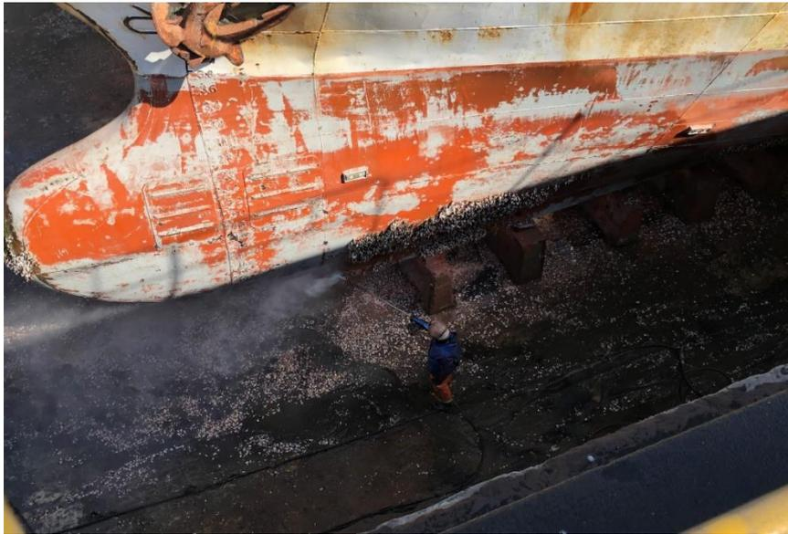
Figura 25. Proceso de Hidrolavado
