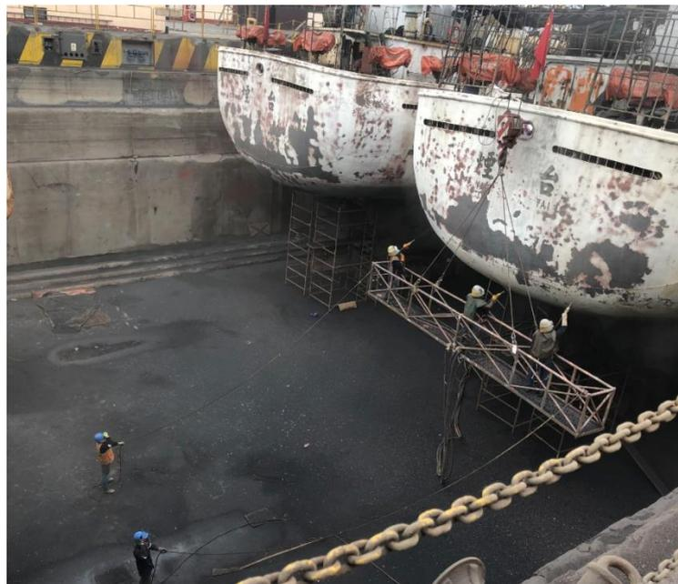
Figura 26. Proceso de arenado
