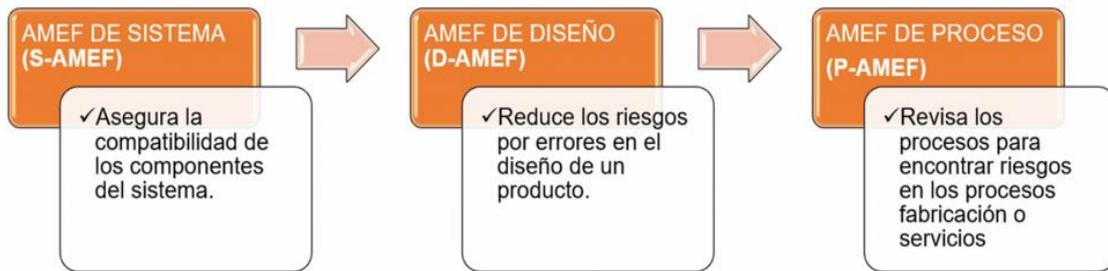
Figura 13. Tipos de Análisis del Modo y Efectos de Fallas
