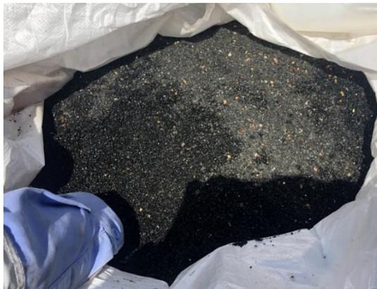
Figura 32. Escoria de cobre en condición húmeda
