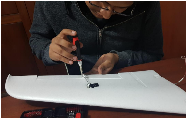
Figura 71 Instalación de micro servos
