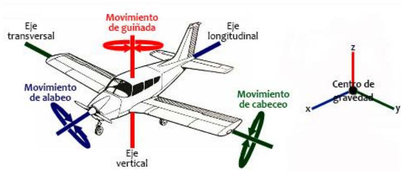
Figura 16 Ejes de traslación y rotación de un aeroplano
