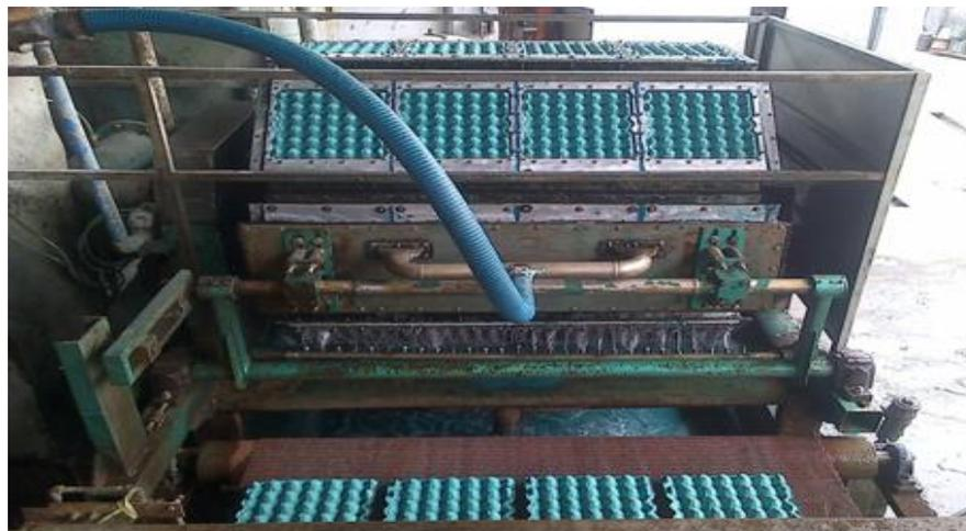
Figura 4. 10: Máquina Conformadora de casilleros x 30
