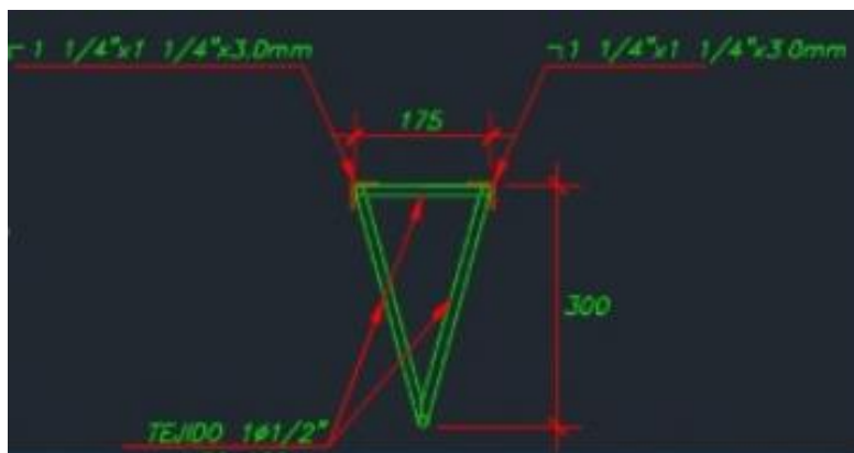
Figura 20. Detalle técnico de viguetas Constructora Lucong SAC.
