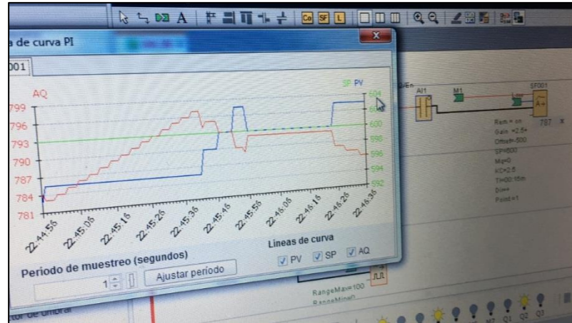
Figura N°70: Pantalla de seguimiento de señales y control PI - Prototipo Fuente: Elaboración propia
