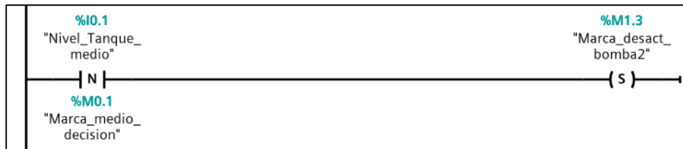
Figura N.º44: Bloque de seteo de marca de bomba 2 Fuente: Elaboración propia
