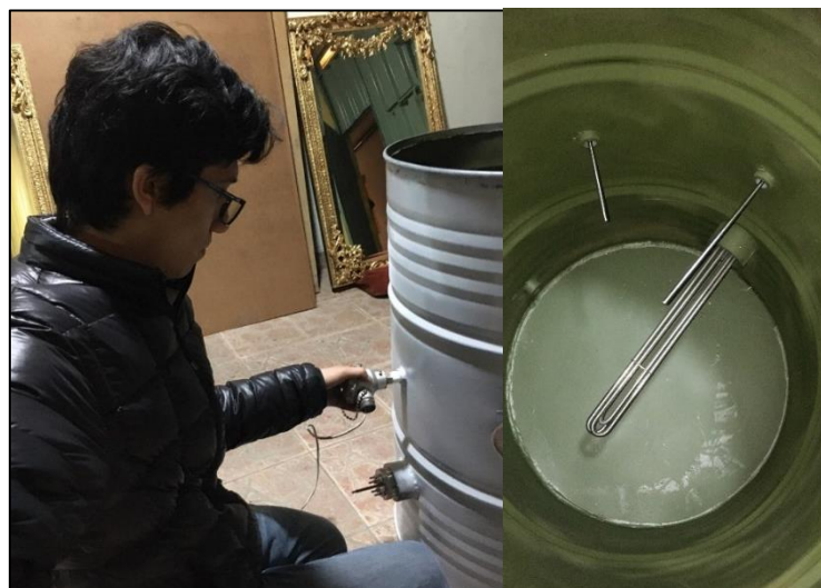
Figura N°63: Instalación de sensor PT100 Fuente: Elaboración propia
