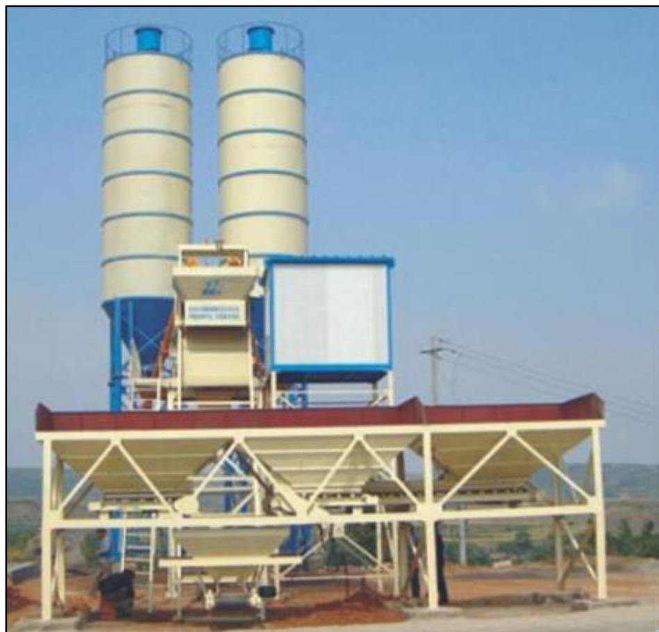
Figura 21: Planta de hormigón Haomei HZS35
