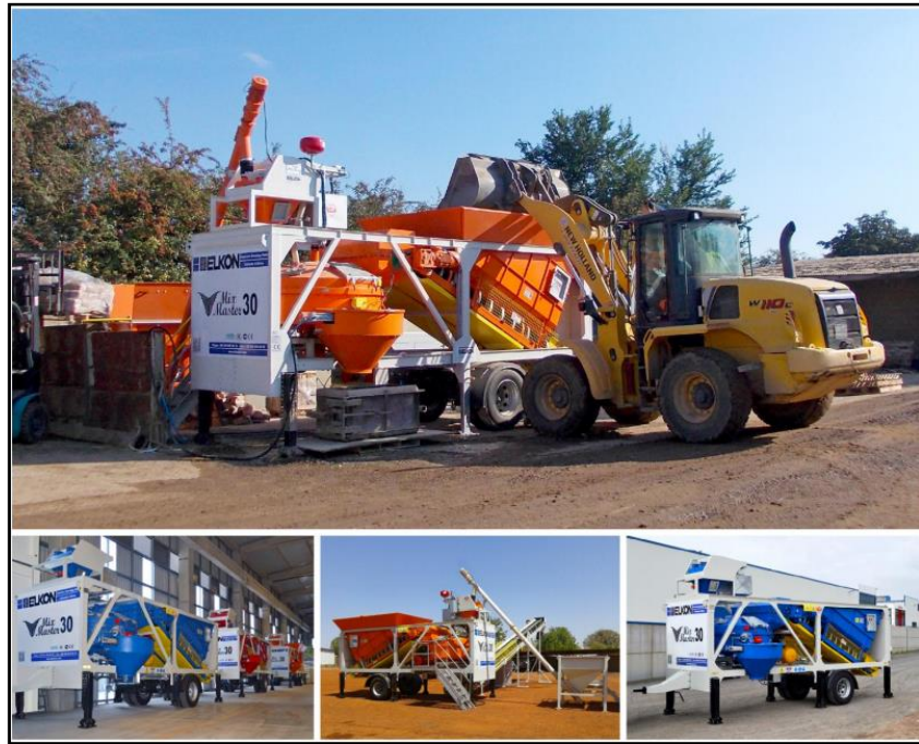
Figura 19: Planta dosificadora de concreto móvil Elkon Mix Master-30
