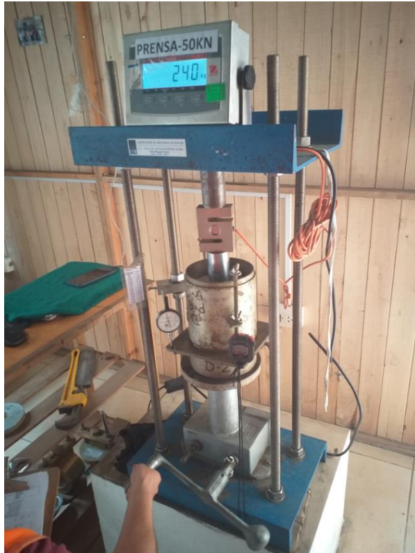
Figura 50: Realizando el ensayo del CBR
