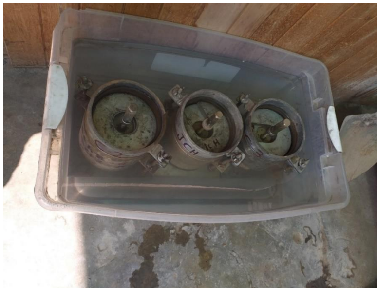
Figura 48: Moldes para el CBR de la mezcla Suelo - Emulsión en saturación
