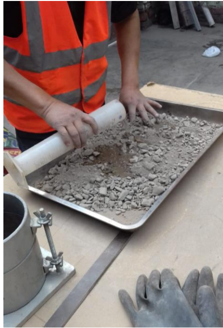
Figura 34: Mezcla de cemento, afirmado y agua
