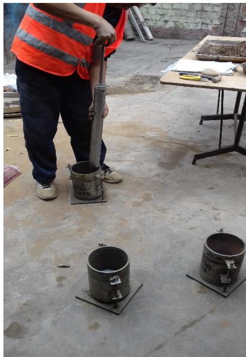
Figura 45: Compactación de CBR de muestra con cemento
