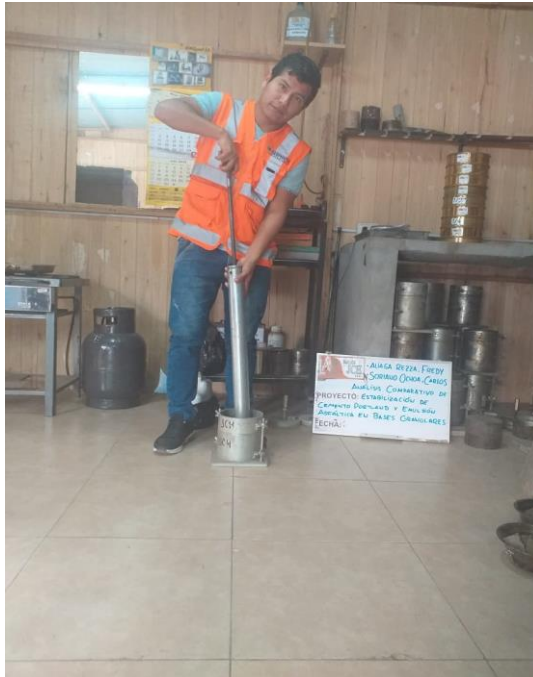
Figura 36: Proceso de compactación de ensayo próctor modificado
