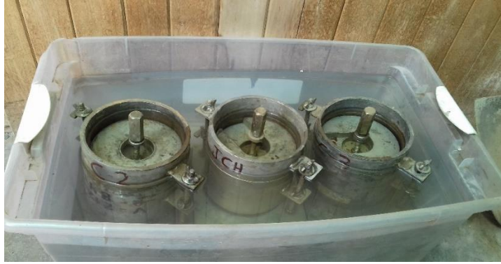
Figura 46: Moldes de CBR de muestra con cemento en saturación
