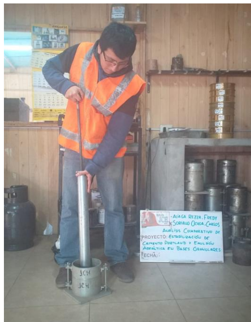
Figura 35: Proceso de compactación de ensayo Próctor modificado
