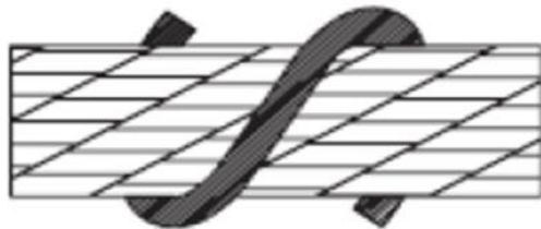
Figura 30 Paso regular izquierdo de un cable
