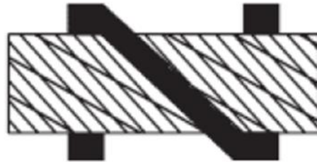
Figura 31 Paso Lang derecho de un cable
