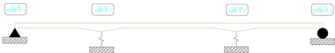
Figura 85 Dispositivos de apoyo en el puente extradosado
