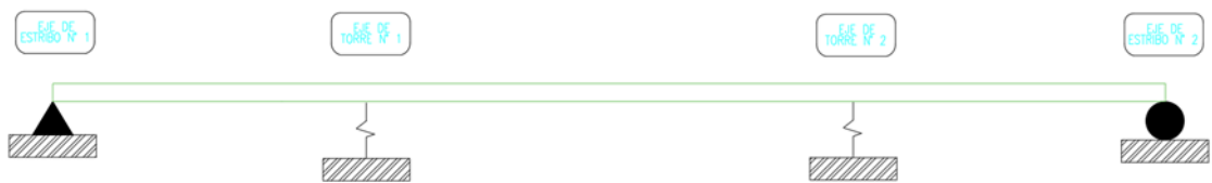
Figura 55 Dispositivos de apoyo en puente atirantado
