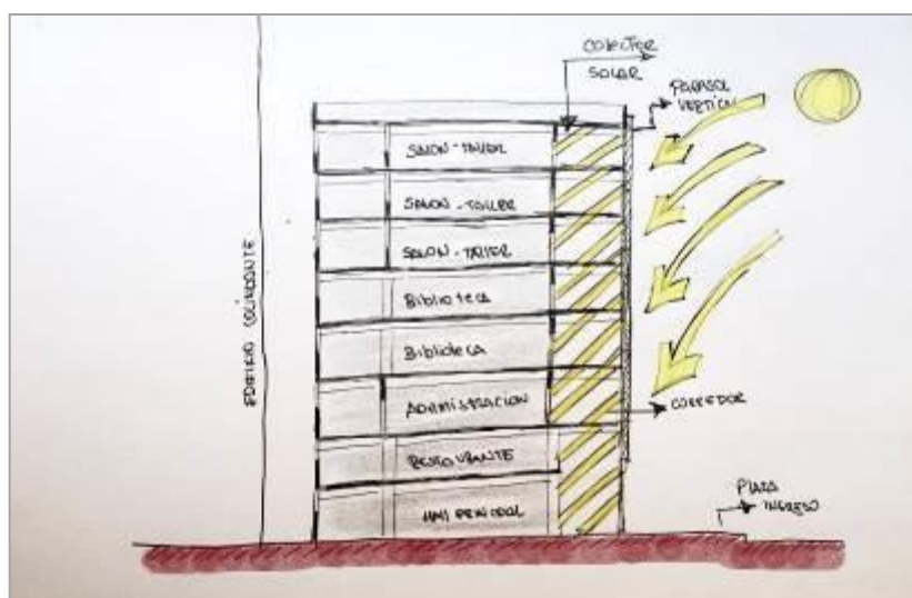
Figuras 103. Esquema del uso de corredores colectores de calor y parasoles verticales en proyecto.
