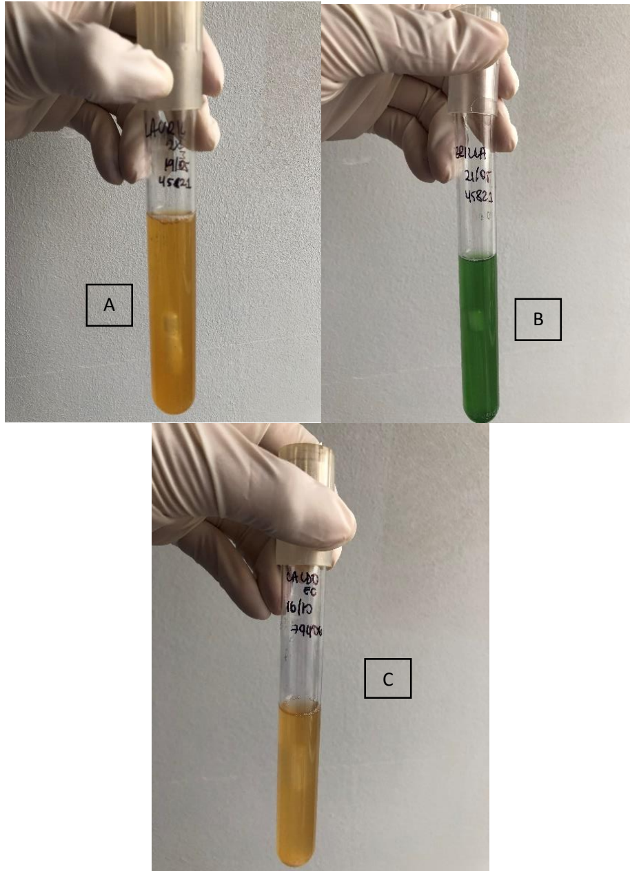
Figura 23. A. Tubo de Caldo Lauril Sulfato 2x positivo. B. Tubo de Caldo Brilla positivo indicando presencia de coliformes totales. C. Tubo de Caldo EC positivo indicando presencia de coliformes fecales.
