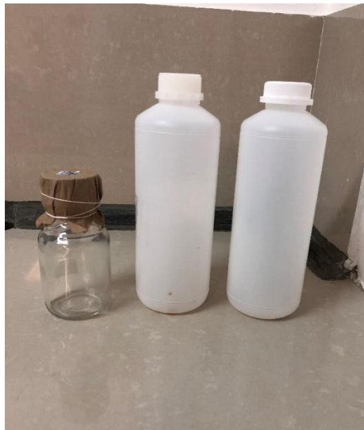
Figura 19. Botellas usadas para el muestreo de agua de consumo humano. (Izquierda a derecha: botella de vidrio de 250 ml con tapa rosca previamente esterilizada, botella de plástico de 1 litro con gotas de lugol y contratapa, botella de plástico de 1 litro con contratapa.
