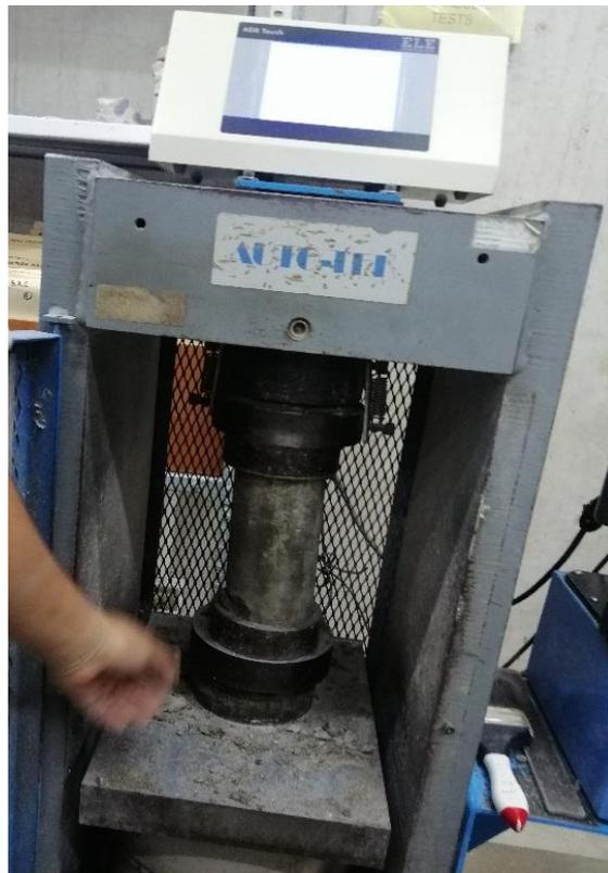
Figura N°20: Ensayo de probetas a compresión en el laboratorio de ensayo de materiales.
