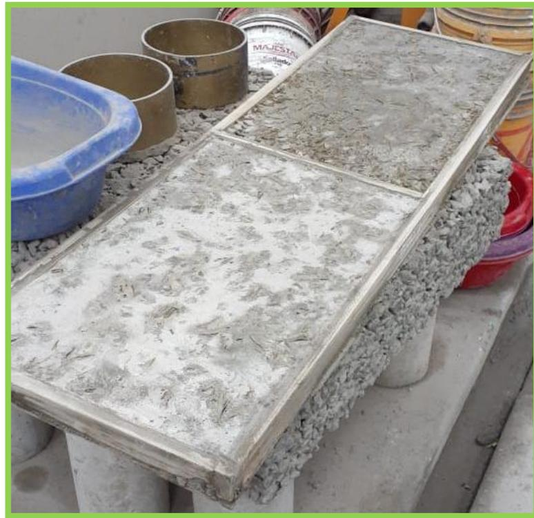
Figura N°38: Losas en estado de fraguado sometido a la temperatura.
