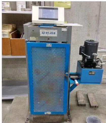
Figura N° 03: Máquina de compresión axial
