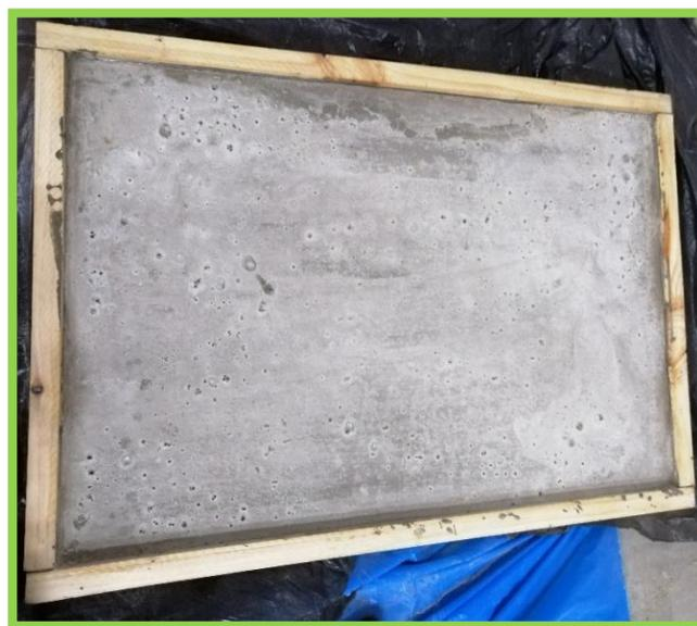
Figura N°39: Fisura Losa 01 muestra patrón (M1) concreto 210 kg/cm<sup>2</sup>.
