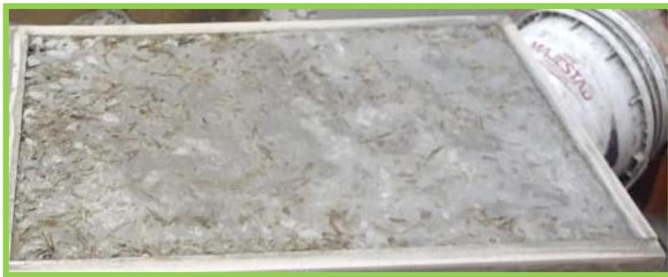
Figura N°42: Fisura Losa 04 muestra fibra con 6,0% de betarraga (M4) concreto 210 kg/cm<sup>2</sup>.
