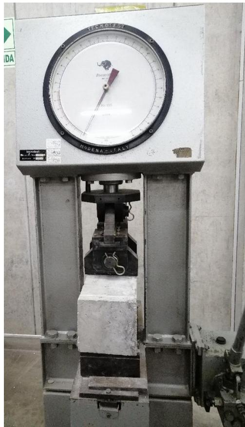
Figura N°32: Ensayo de vigas a flexión en el laboratorio de ensayo de materiales.
