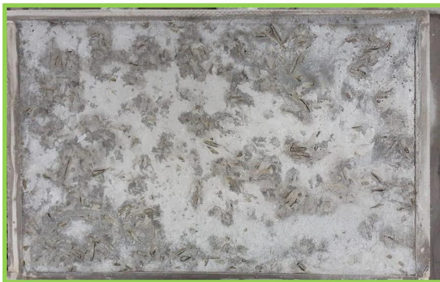
Figura N°40: Fisura Losa 01 muestra fibra con 1,5% de betarraga (M2) concreto 210 kg/cm<sup>2</sup>.
