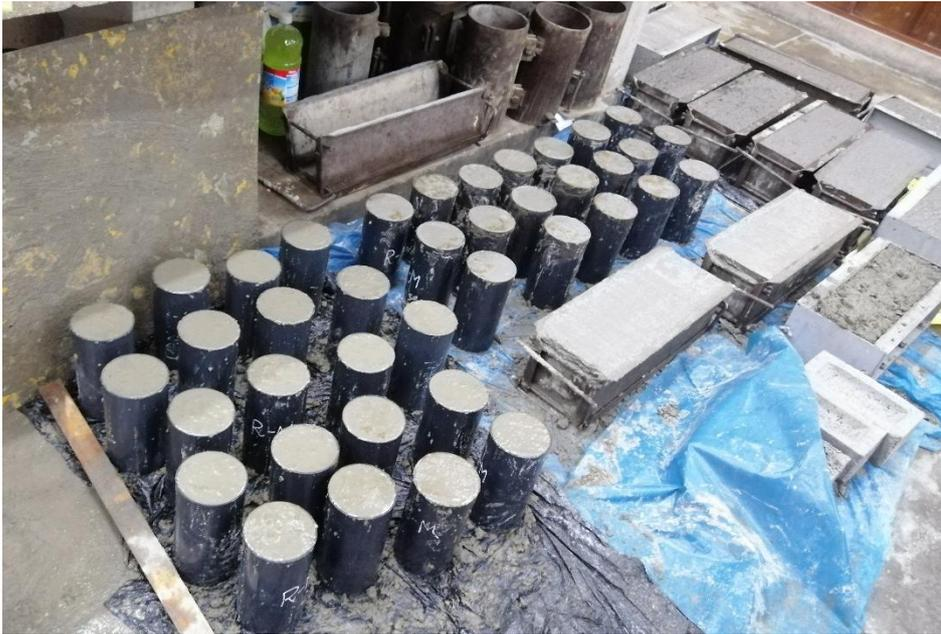
**Anexo 4:** Curado de probetas y vigas
