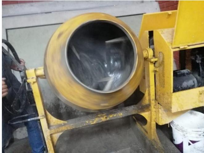
Figura N° 02: Mezcladora de concreto
