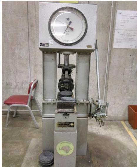
Figura N°4: Máquina de flexión
