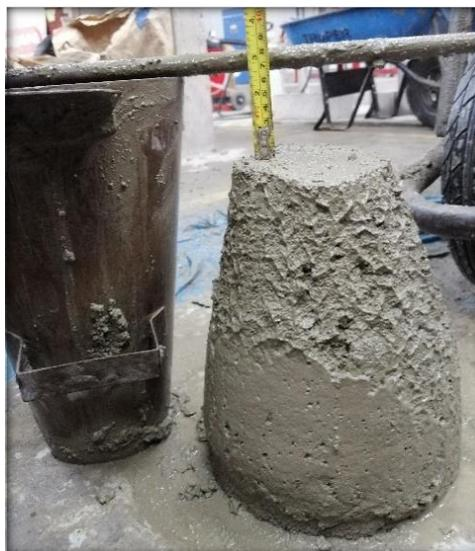
Figura N°19: Medición de asentamiento
