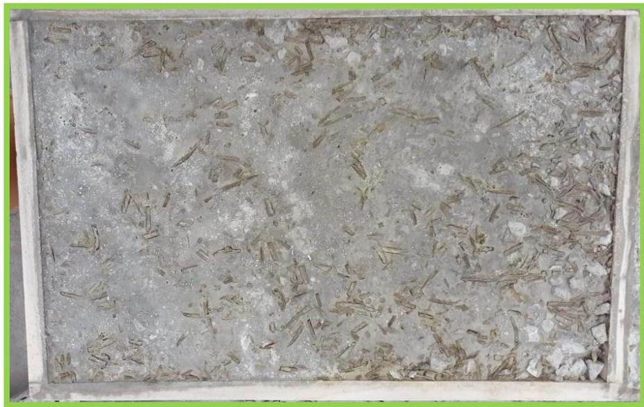
Figura N°41: Fisura Losa 01 muestra fibra con 3,0% de betarraga (M3) concreto 210 kg/cm<sup>2</sup>.
