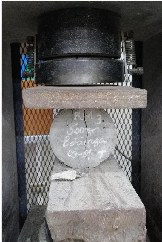
Figura N°26: Ensayo de probetas a tracción en el laboratorio de ensayo de materiales.
