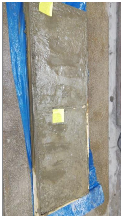
Figura 18 Losas de 0.5% y de 1% con fibra de zanahoria
