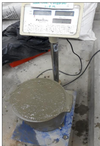
Figura 13: Ensayo de Peso unitario 1
