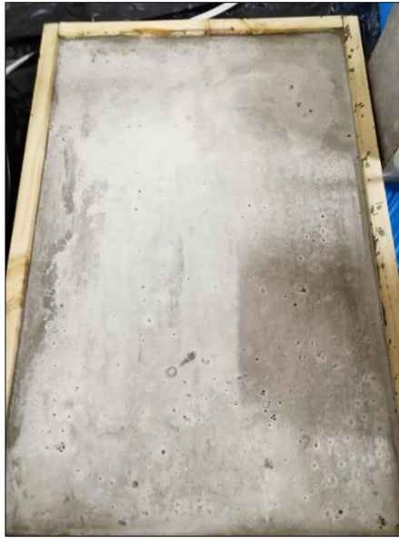
Figura 17 Losa sin fisuras con 1.75% de la fibra de zanahoria
