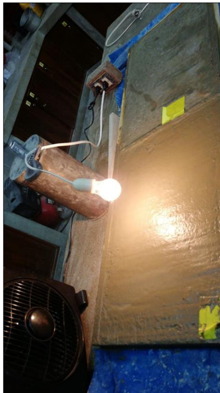
Figura 20 Tratamiento a la losa, sometida a calor y a aire Fuente: Elaboración propia
