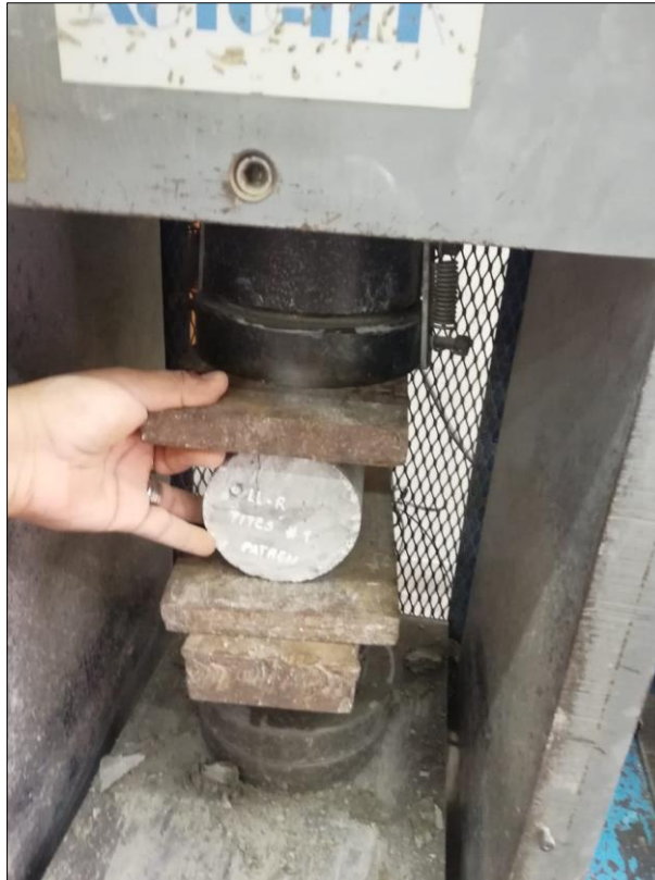
Figura 15 Rotura a la tracción
