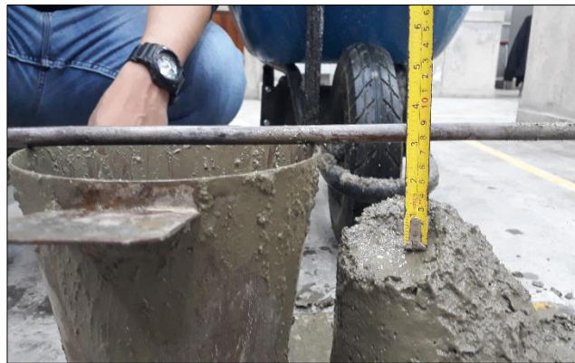
Figura 11: Slump obtenido 3 Fuente: Elaboración propia
