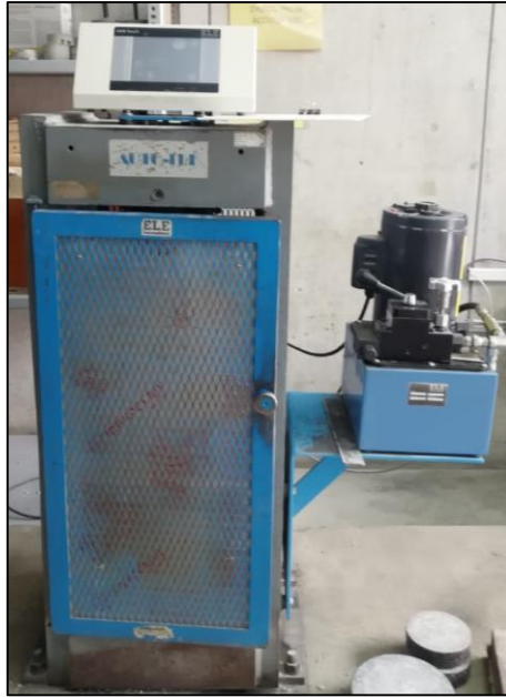
Figura 2 Prensa digital para ensayos de compresión y tracción
