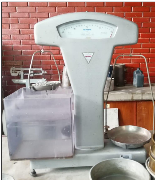
Figura 7 Maquina para peso específico agregado grueso
