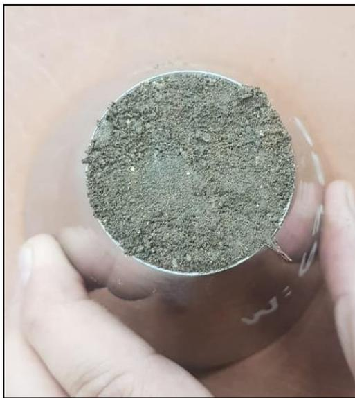
Figura N° 66: Aplonado y enrasado de la muestra
