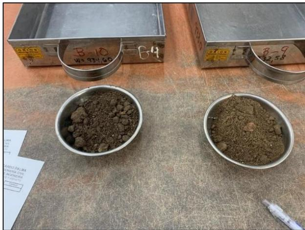
Figura N° 49: Muestras para el Contenido de Humedad
