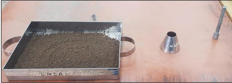
Figura N° 65: Instrumentos para ensayo de Densidad
