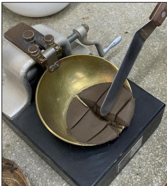
Figura N° 56: Selección de la muestra cerrada a 13mm
