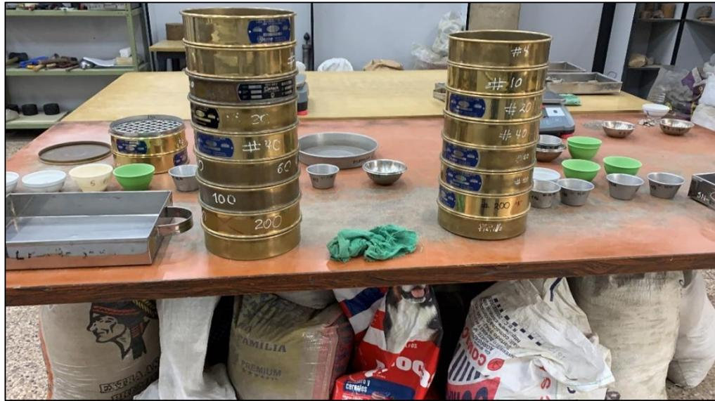
Figura N° 51: Juego de tamices y tamizado del suelo
