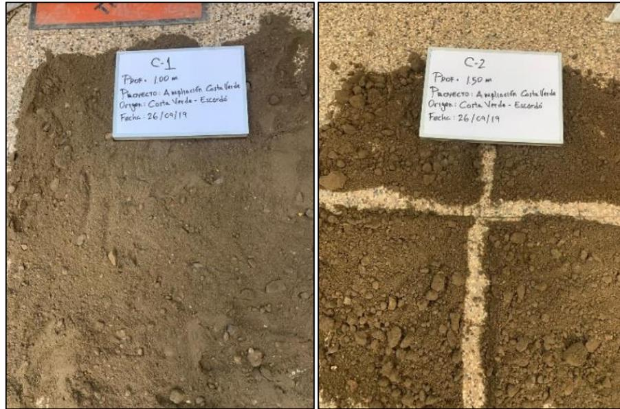
Figura N° 46: Calicatas a diferentes Alturas ( $H_1 = 1.00\text{m}$  y  $H_2 = 1.50\text{m}$ .) obtenidas del Tramo Costa Verde, Escardó-Virú.
