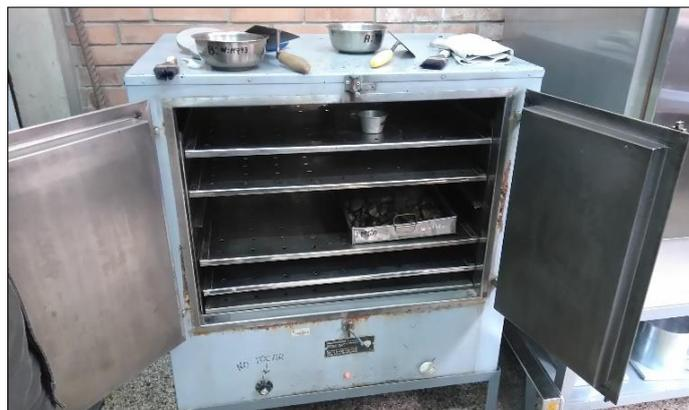
Figura N° 50: Secado de muestras
