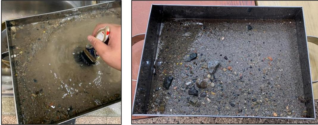
Figura N° 48: Lavado de muestras previo al secado para ensayo granulométrico
