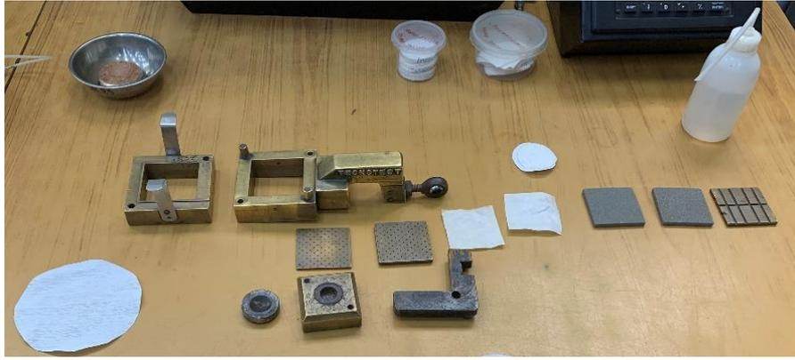
Figura N° 60: Máquina de Corte y sus partes
