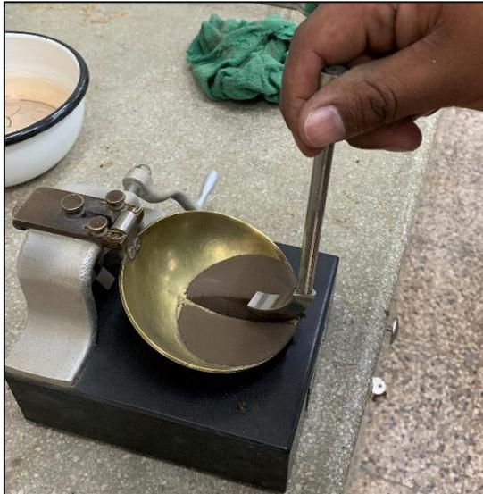
Figura N° 55: Ranurado de la muestra
