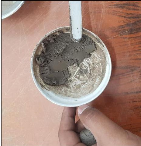
Figura N° 53: Mezcla del suelo con agua
