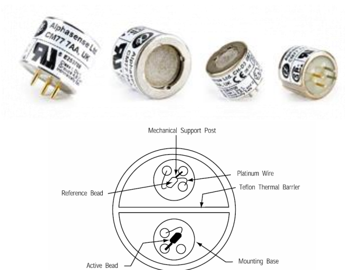
Figura 16. Encapsulados típicos de sensores de gas catalíticos
