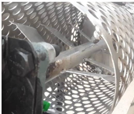
Figura N°46 Rotación de las paletas despalladoras
