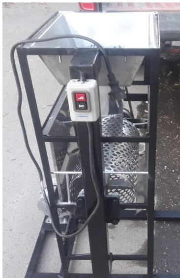
Figura N°65 Sistema de encendido y motor monofásico
