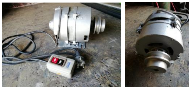
Figura N°63 Colocación de mando en motor 0,75Hp
