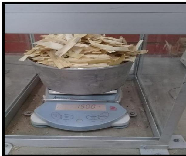
Figura 23: Peso de las fibras de panca seca de maíz al 1.0%
