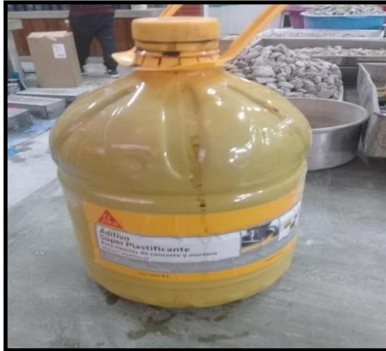
Figura 24: Aditivo superplastificante SikaCem
