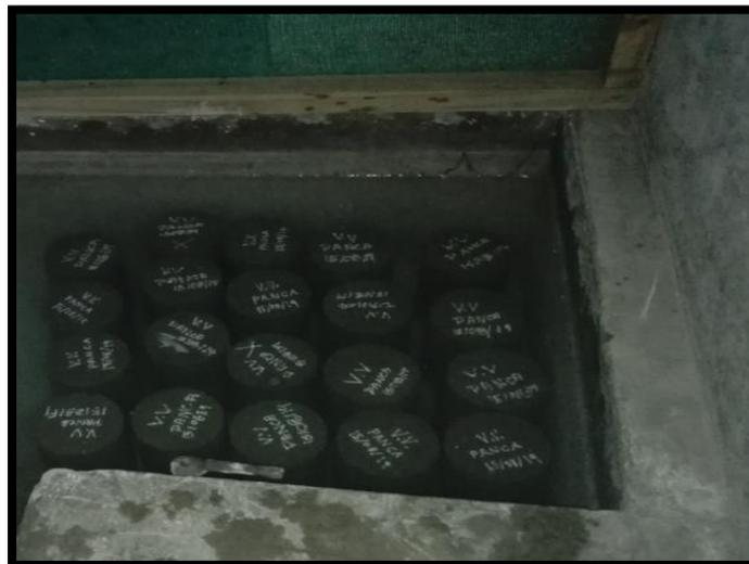
Figura 21: Puesta de las probetas para su respectivo curado a los 7, 14 y 28 días
