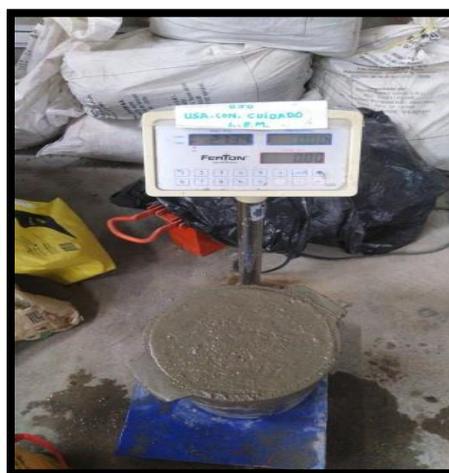
Figura 28: Pesando el molde más la mezcla patrón para el ensayo de peso unitario
