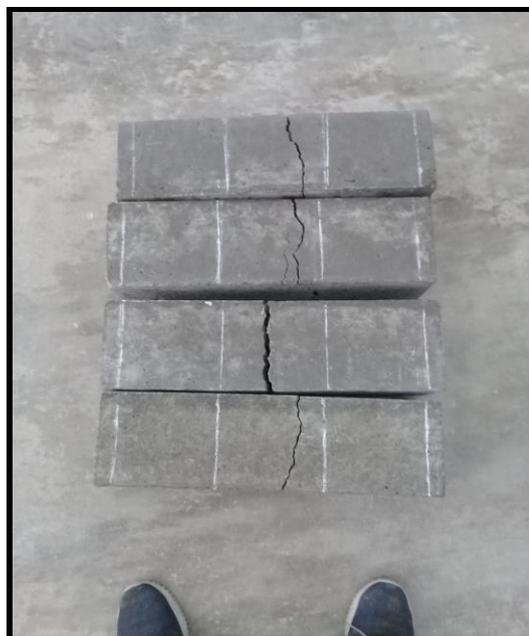
Figura 16: Rotura de vigas (Fallan dentro del tercio central)
