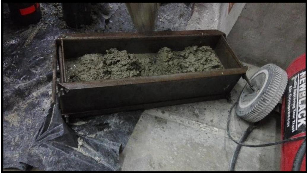
Figura 14: Previo engrasado, se procederá al vaciado de mezcla patrón en las vigas, siendo el procedimiento de 15 apisonadas en 5 filas a lo ancho de la viga, tanto como los golpes laterales con el martillo de goma, todo esto a dos capas, y finalizar con el engrasado
