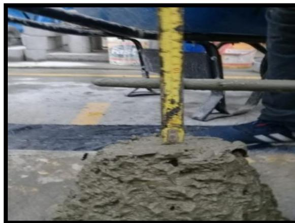
Figura 26: Se muestra el asentamiento de 3''1/2 para la mezcla con adición de fibra de panca seca de maíz al 0.5%
