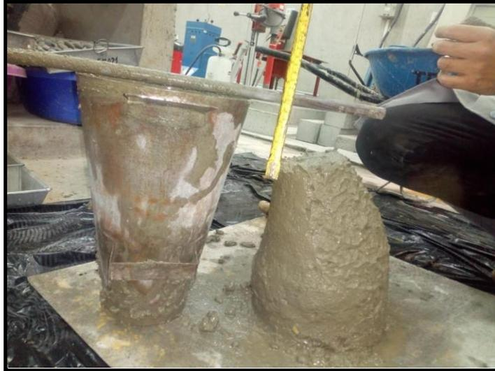
Figura 12: Realizando el Slump con la adición de fibras de panca seca de maíz al 0.5%
