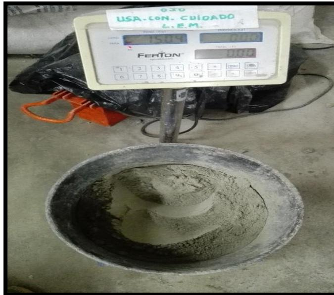
Figura 8: Pesando el cemento
