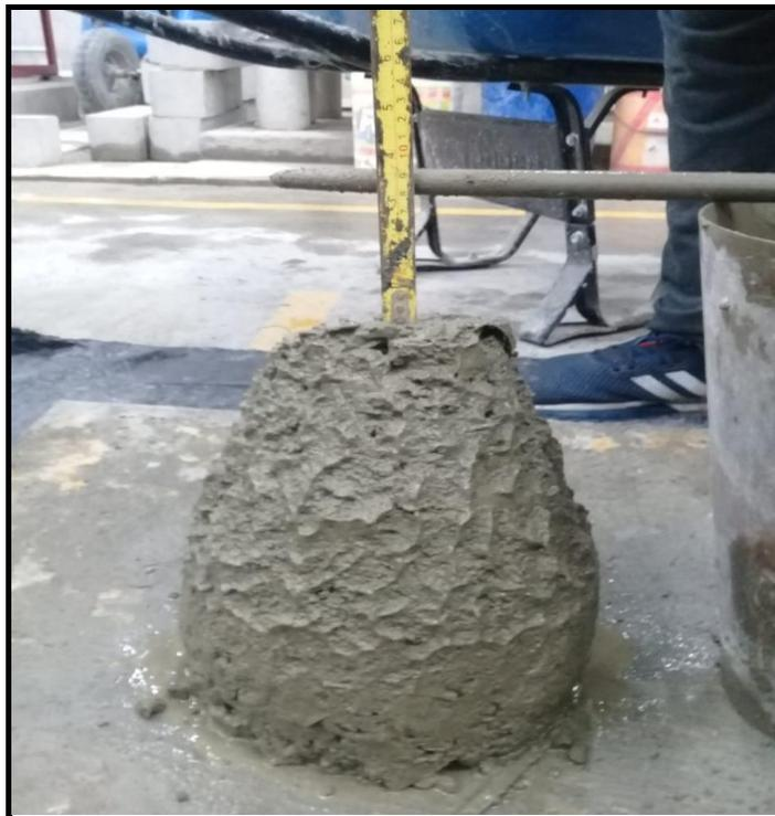
Figura 13: Tomando la medida del Slump con 1% de fibras .
