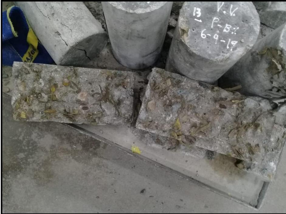
Figura 18: Fibras de panca seca de maíz en la rotura a tracción.
