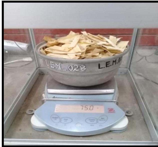
Figura 22: Peso de las fibras de panca seca de maíz al 0.5%
