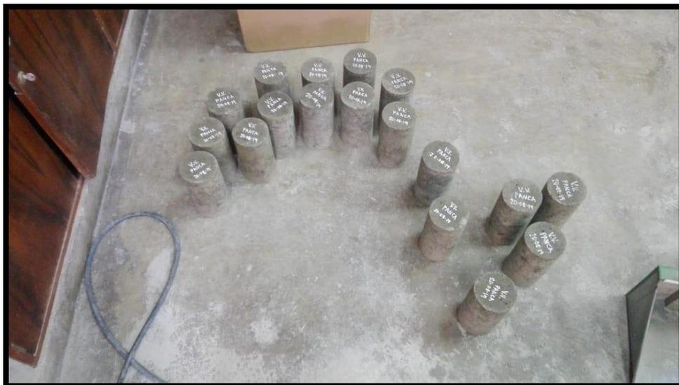
Figura 19: Desencofrado de las probetas
