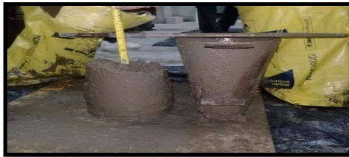
Figura 25: Se muestra el asentamiento de 4'' para la mezcla patrón
