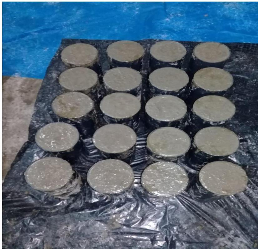
Figura 11: Mezcla patrón vacada en probetas
