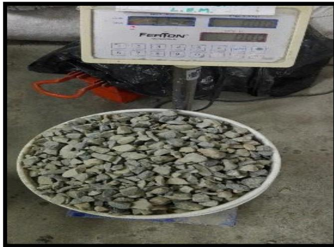
Figura 6: Pesando el agregado grueso
