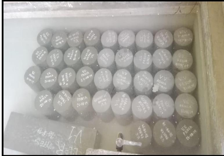
Figura 10: Introduciendo las probetas en la piscina
