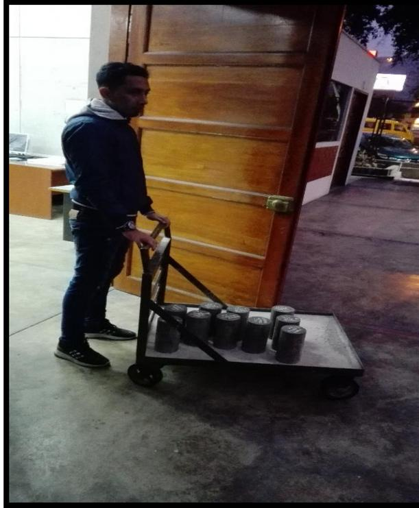
Figura 20: Traslado de las muestras de las probetas de concreto para curarlas
