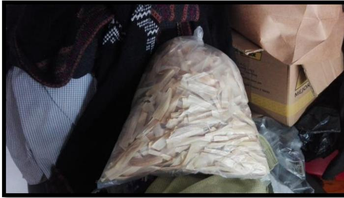
Figura 5: Cantidades estipuladas de fibra de panca seca de maíz que se utilizarán en la mezcla de concreto
