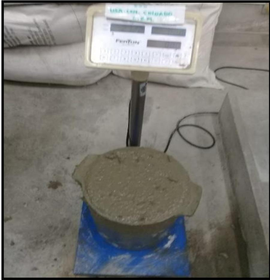
Figura 29: Pesando el molde más la mezcla con adición de fibra de panca seca de maíz al 0.5%
