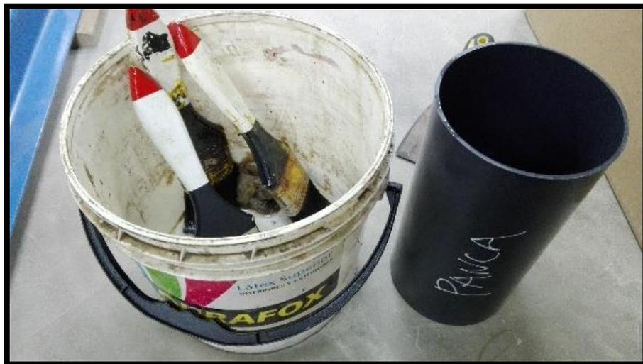
Figura 15: Se engrasará las paredes interiores de la probeta
