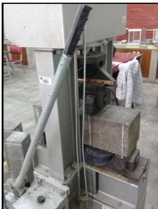
Figura 17: Realizando resistencia a la flexion de viga patrón.
