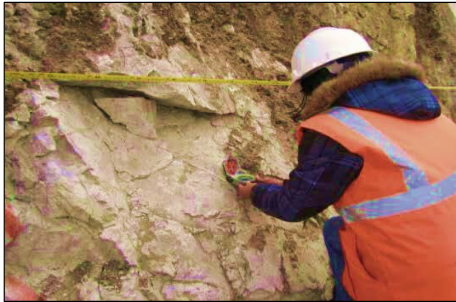
Figura 36: Mapeo geomecánico por líneas de detalle de la cara del talud
