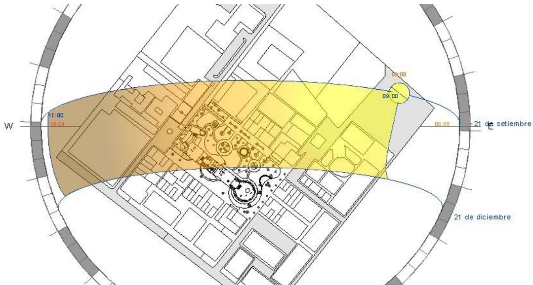
Figura 31. Recorrido solar en primavera. Fuente: Imagen propia usando el software Revit.
