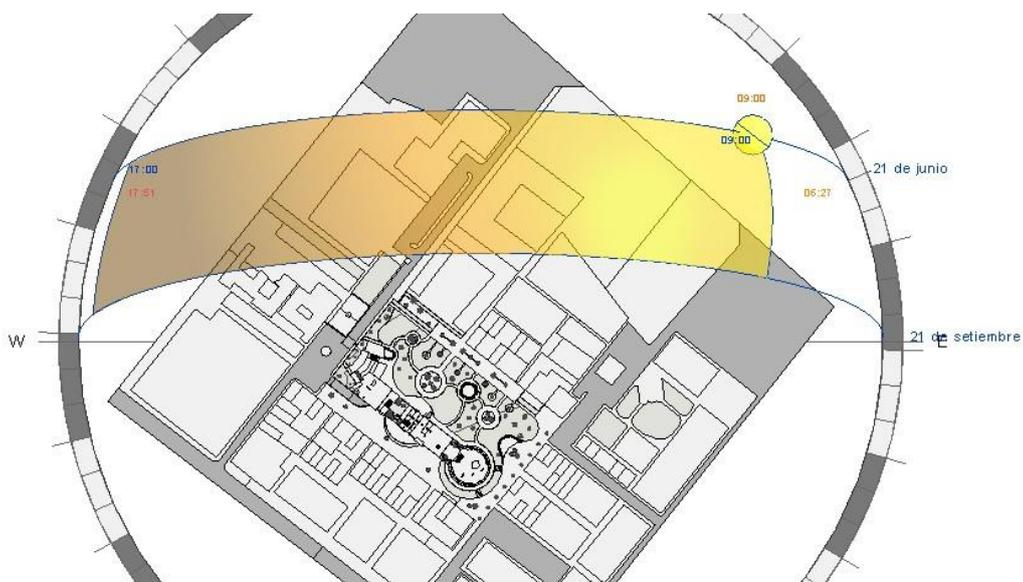
Figura 32. Recorrido solar en invierno. Fuente: Imagen propia usando el software Revit.
