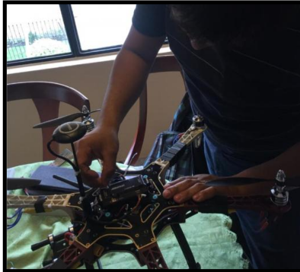
Figura 116. Instalación de controladora de vuelo en drone hexacóptero
