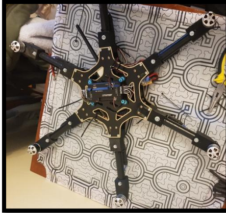
Figura 92. Instalación de las 6 patas en la base central
