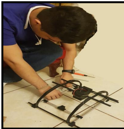
Figura 99. Ensamblaje de la estructura de soporte del sistema de eyección
