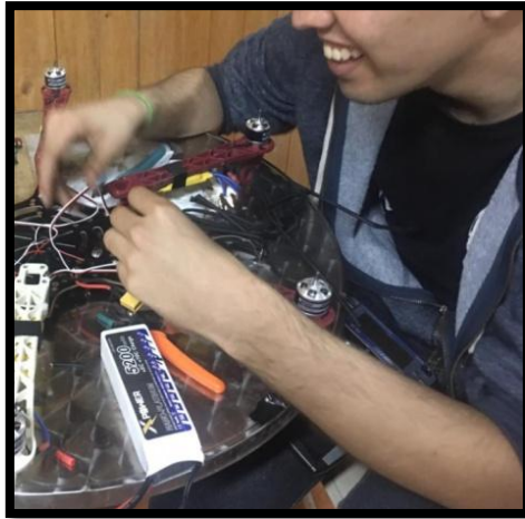
Figura 112. Instalación de Batería
