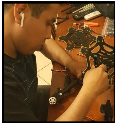
Figura 87. Instalación de la primera pata a la base central
