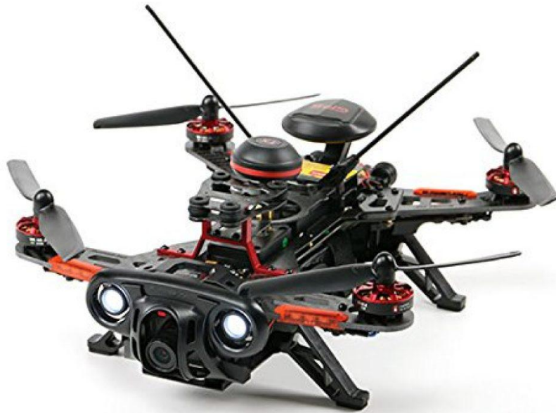
Figura 7. Drone de carrera con sensores de telemetría y sistema de vista en primera persona
