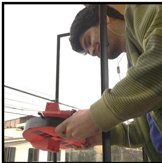
Figura 126. Lanzamiento de capsulas de pintura con movimientos oscilantes de amplitud de 30 mm
