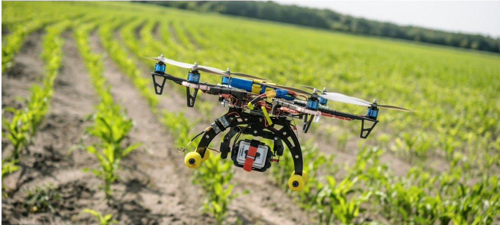
Figura 6. Multirrotores propulsados por un sistema de 6 motores
