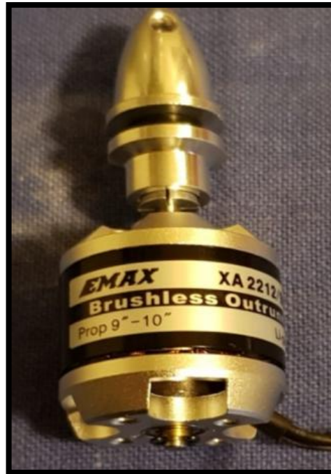
Figura 81. Motor Emax XA2212
