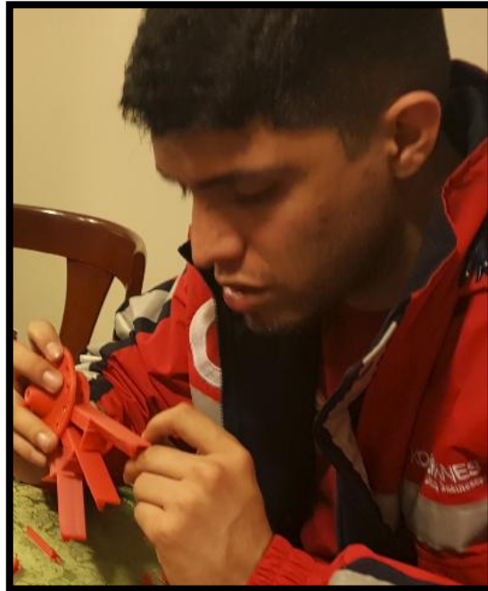
Figura 102. Armado del eje de rotación con paredes laterales
