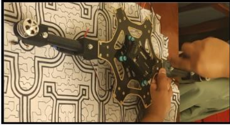
Figura 88. Instalación de la segunda pata a la base central
