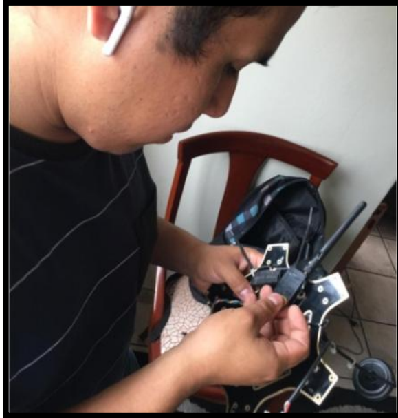
Figura 114. Instalación de telemetría, GPS y antena de radio control
