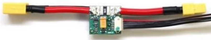
Figura 72. Power module encargado de regular el voltaje de la batería secundaria
