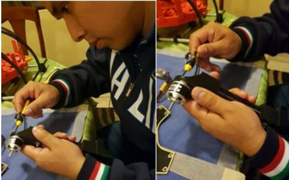
Figura 82. Instalación de motor en soporte
