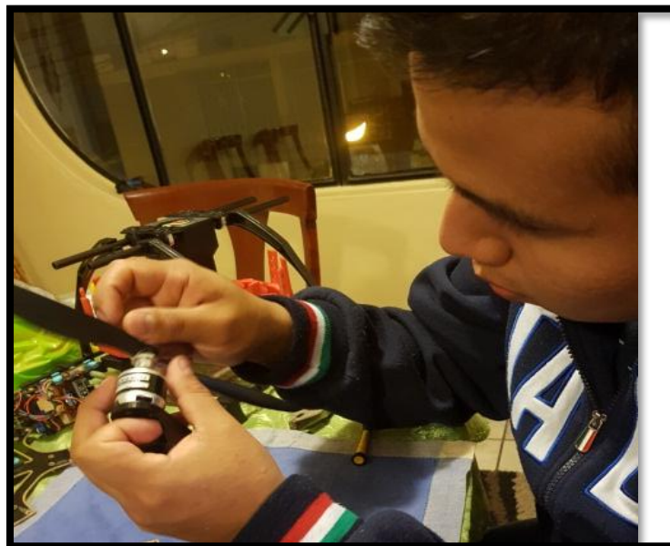
Figura 85. Instalación de las hélices en los brazos
