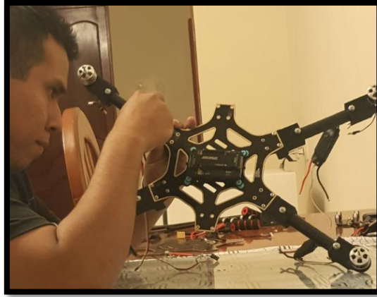
Figura 90. Instalación de la cuarta pata a la base central
